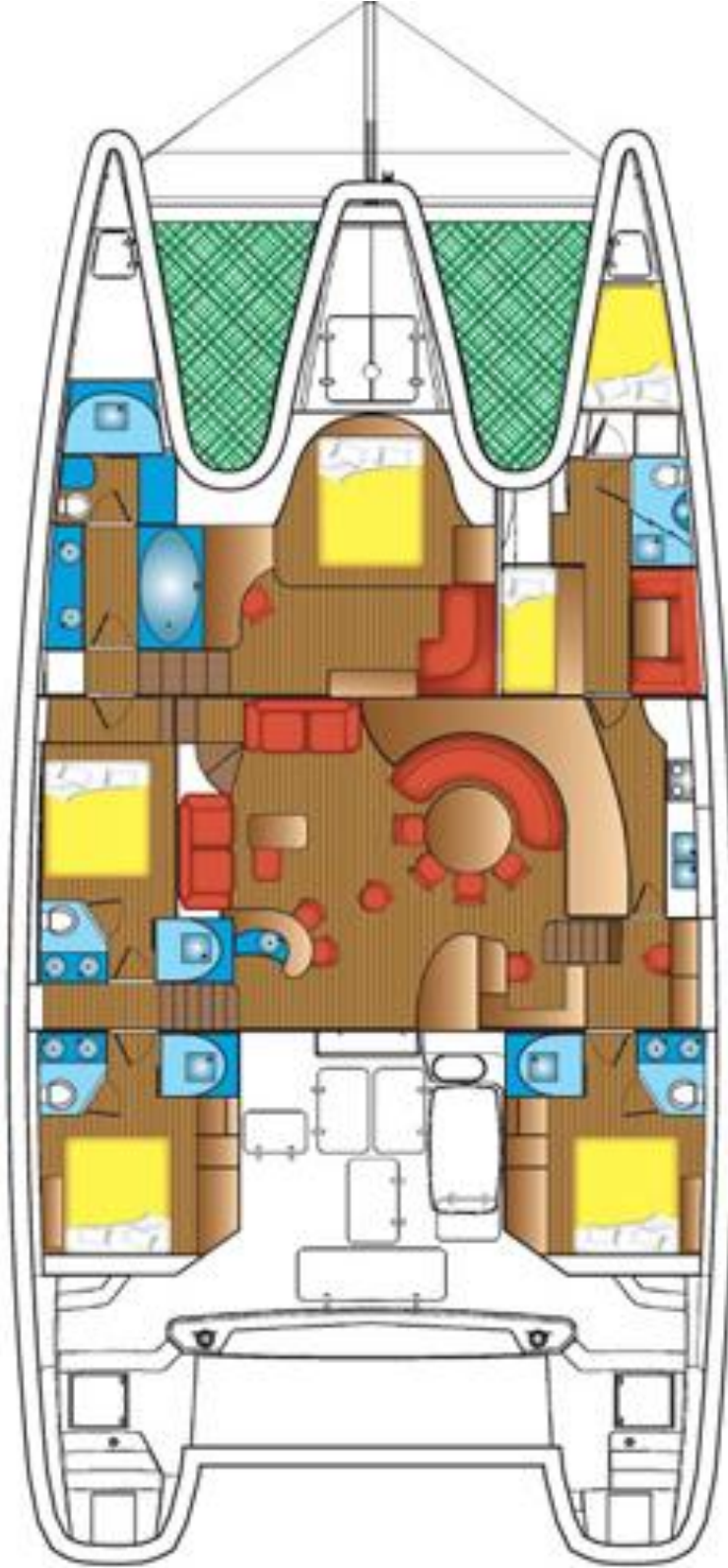
Şekil 3.10 Çok gövdeli yat (katamaran) güverte plan yerleşimi (Matau; 22,86 metre; Marc Lombard/ Privilege Design).
