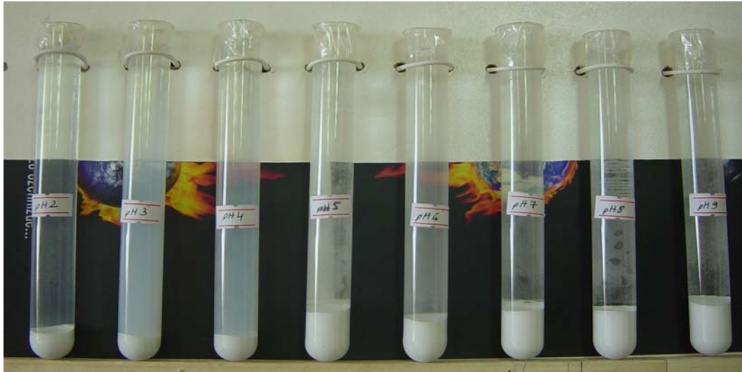
Şekil 3.41 Sedimentasyon test sonuçları.
