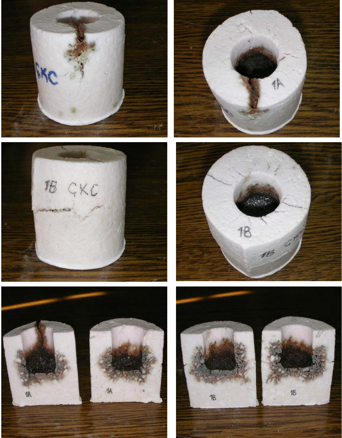
Şekil 3.43 Çelikhane konverter cürufu kullanılan 1A ve 1B korozyon test numunelerinin kesit görüntüleri.
