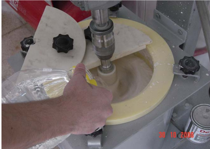
Şekil 2.9 Öğütme deneylerinde kullanılan 10 L hacimli atritör değirmen (Eskişehir Anadolu Üniversitesi Seramik Araştırma Merkezi Laboratuvarı).
