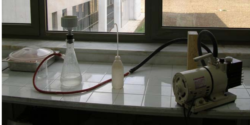
Şekil 2.7 Yıkanmış gibsitin süzülmesi.
