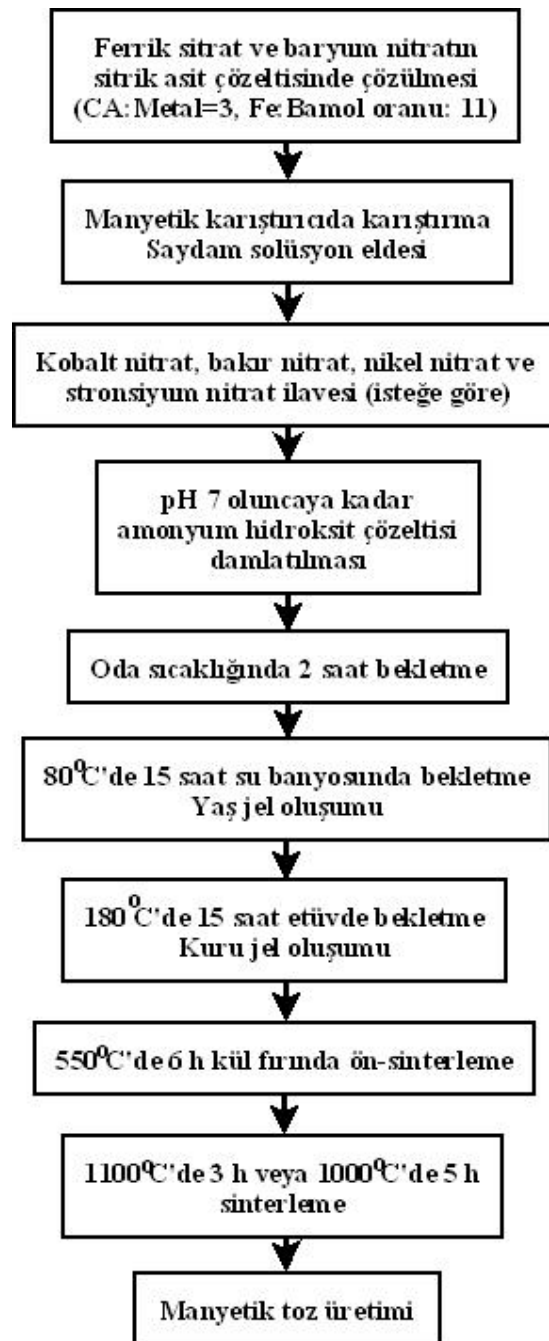
Şekil 2.1 Doplanmış ve doplanmamış baryum ferrit tozlarının sitrat sol-jel yöntemi ile üretilmesi için işlem akışı.
