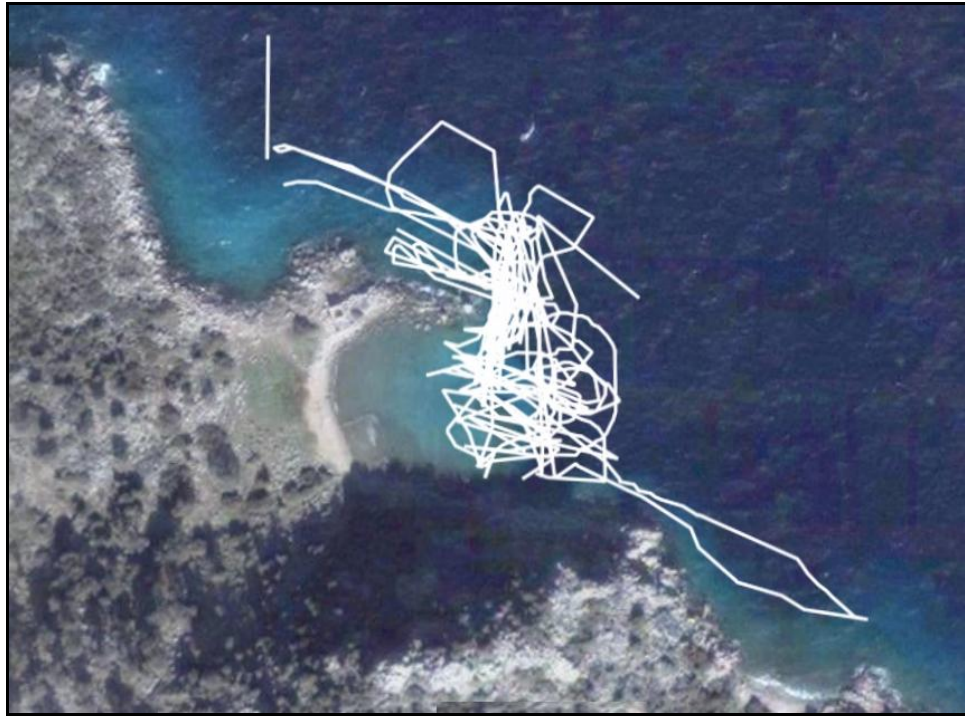
Şekil 4.30 İncirliada antik liman kalıntısı üzerinde gerçekleştirilen ekosounder ve yanal taramalı sonar çalışmalarının hatları. İçteki şekilde dalgakıranın uydu fotoğrafı görülmektedir.
