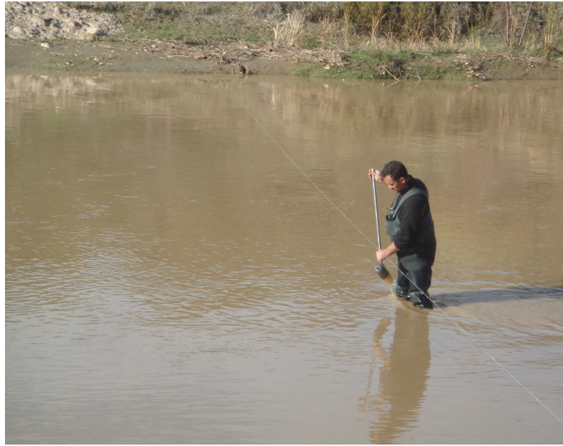
Şekil 2.6 Gediz Nehri'nde USDH-48 ile gerçekleştirilen bir ölçüm
