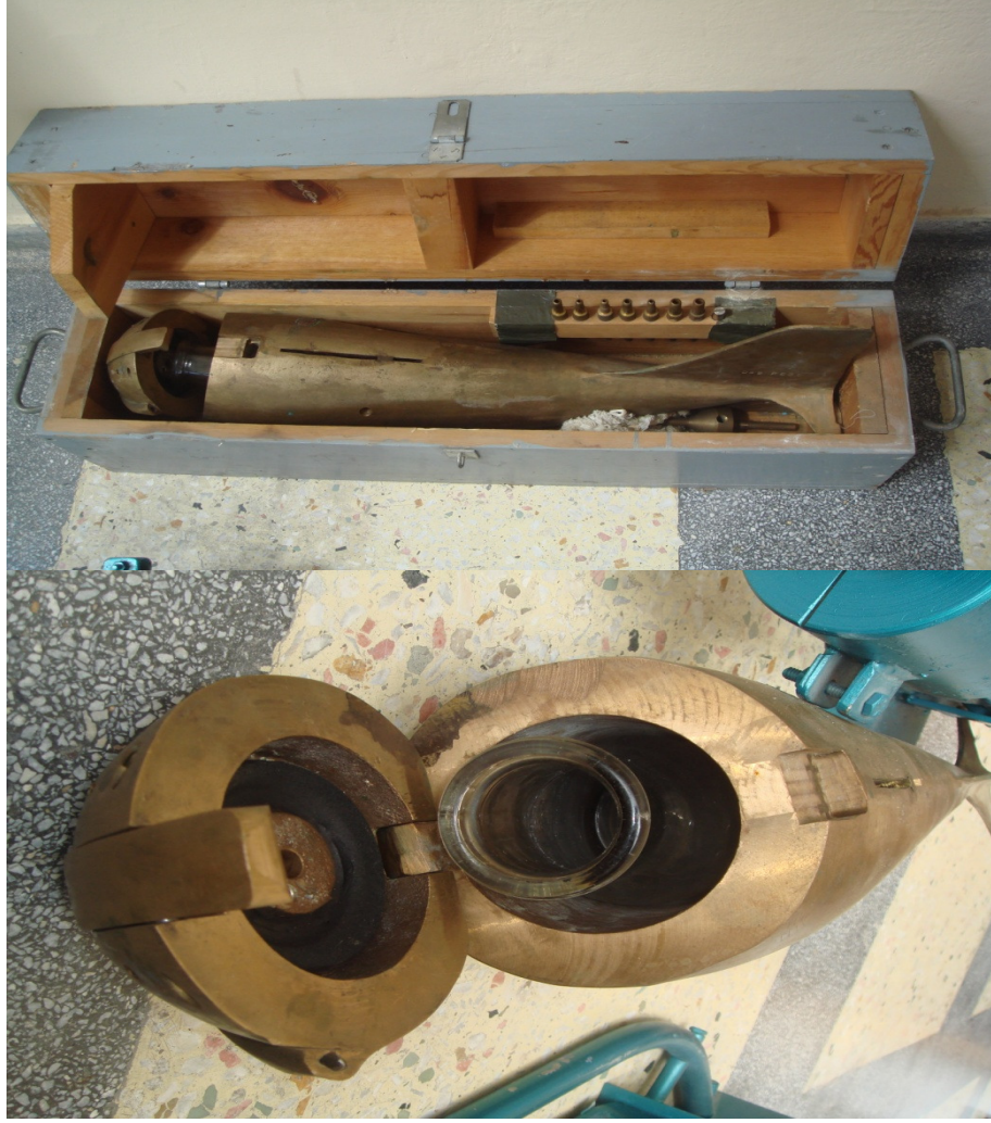
Şekil 2.7 USD-49 Askıda katı madde numune alma aleti (USD-49)
