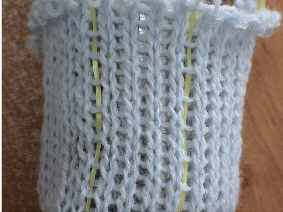
Şekil 2.49 (b) Tüp formda üretilmiş çözümlü örme kumaş numunesinin daire kesitli kalıp üzerine geçirilmiş hali
