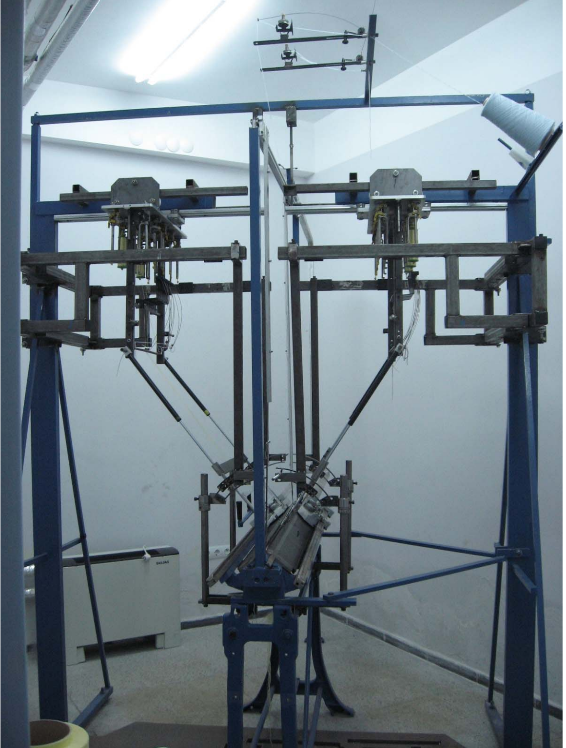
Şekil 2.47 (a) Tez kapsamında geliştirilmiş olan çözümlü yatırım düzeneği ve el örme makinesi
