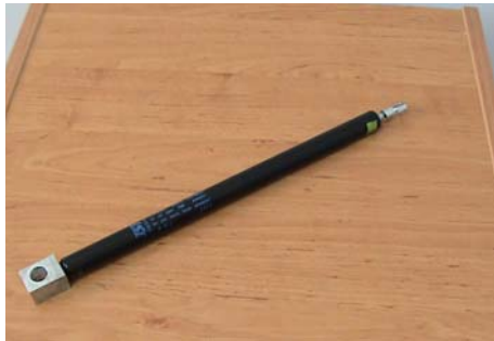
(d) (e) Şekil 2.31 Pistonlu kol (a) önden görünüş, (b) üstten görünüş, (c) alttan görünüş, (d) kısa halinin fotoğrafı, (e) uzamış halinin fotoğrafı
