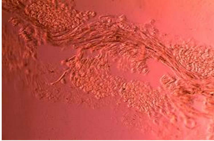
Şekil 3.18 Ham perlit ile tek taraflı kaplanmış kumaş kesiti görüntüsü
