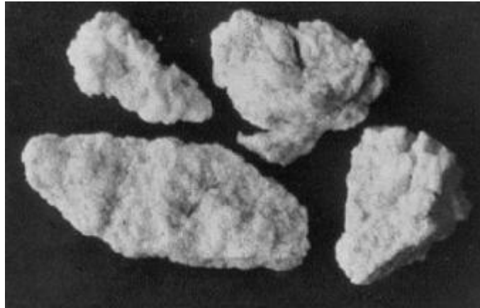
Şekil 1.3 Genleştirilmiş perlit – 900 °C'de 15 s süre ile geliştirilmiş (8x) (Varuzhanyan, Varuzhanyan ve Varuzhanyan, 2006)
