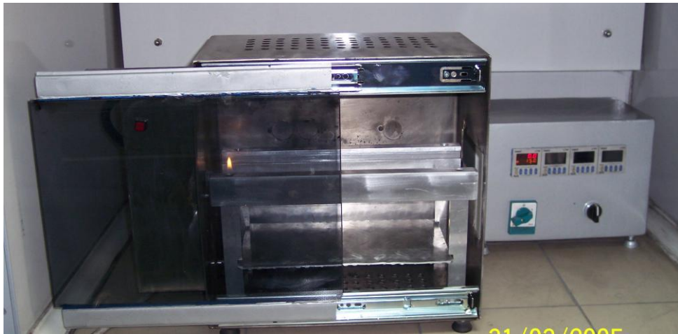
Şekil 2.5 Yatay yakma test cihazı
