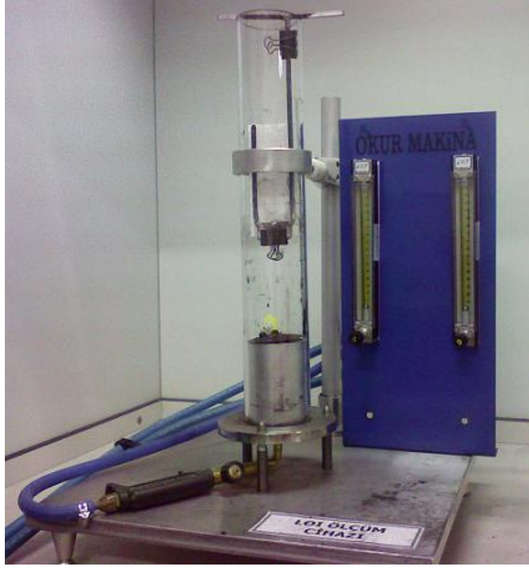
Şekil 2.6 LOI ölçüm düzeneği
