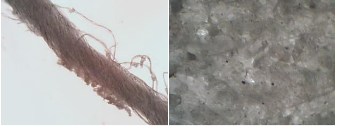
Şekil 3.4 Ham perlit ile tek taraflı kaplanmış kumaştan mikroskop altında iplik (sol) ve kumaş yüzeyi (sağ) görünüşleri
