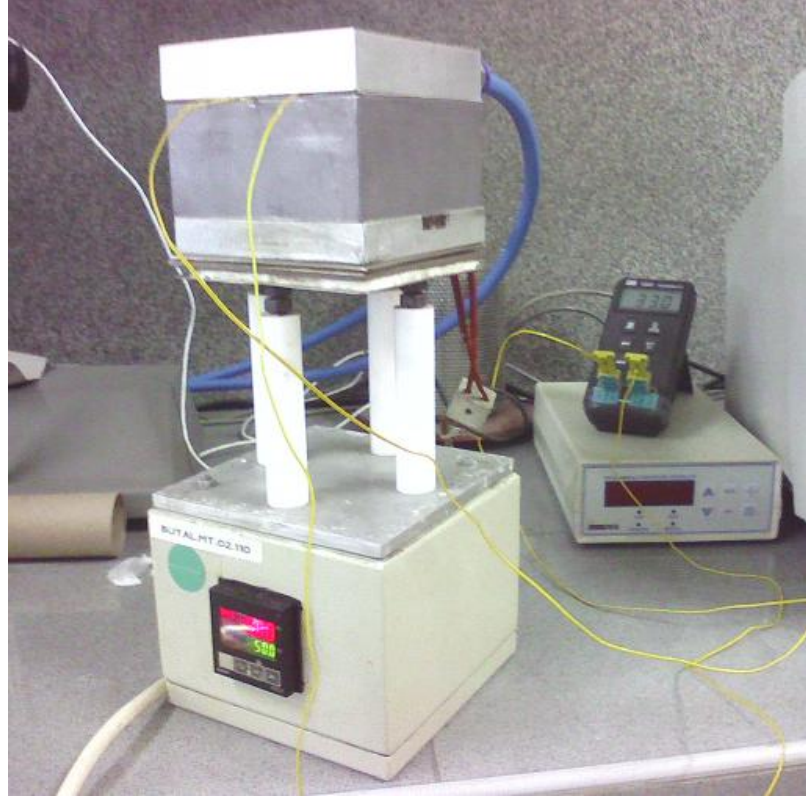
Şekil 2.10 Isıl iletim test cihazı
