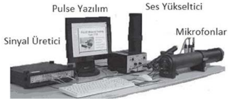
Şekil 2.8 Brüel & Kjaer 4206 iki mikrofonlu akustik empedans tüpü ölçüm düzeneği (Hassall ve Zaveri, 1988)
