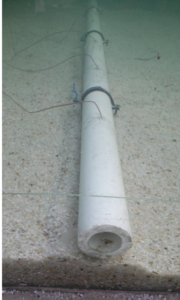
Şekil 4.15 Boru altında zamana bağlı oyulma derinliği ölçümü için yerleştirilen UVP algılayıcıları.
