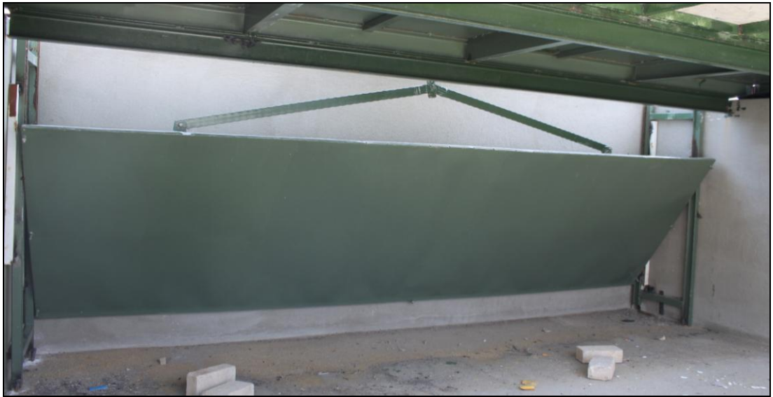
Şekil 4.9 Dalga dubası genel görünümü ve kılavuz raylar.
