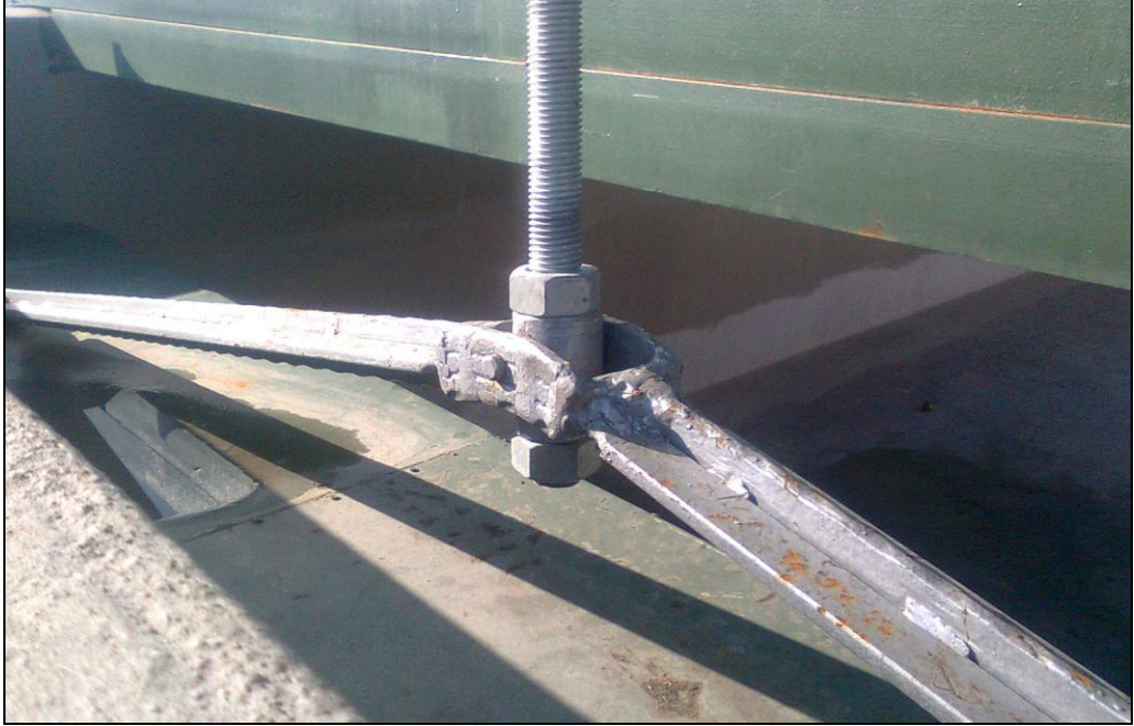
Şekil 4.10 Eksantrik kolu ile dalga dubası bağlantıları birleşim detayı.
