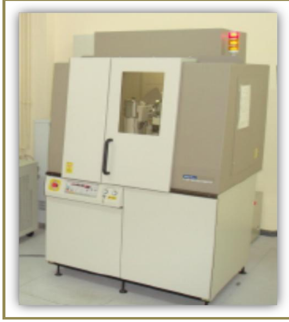
Şekil 3.3 X-ışınları kırınım cihazı - RIGAKU D/Max-2200/PC (X-ışınları Lab., DEÜ)
