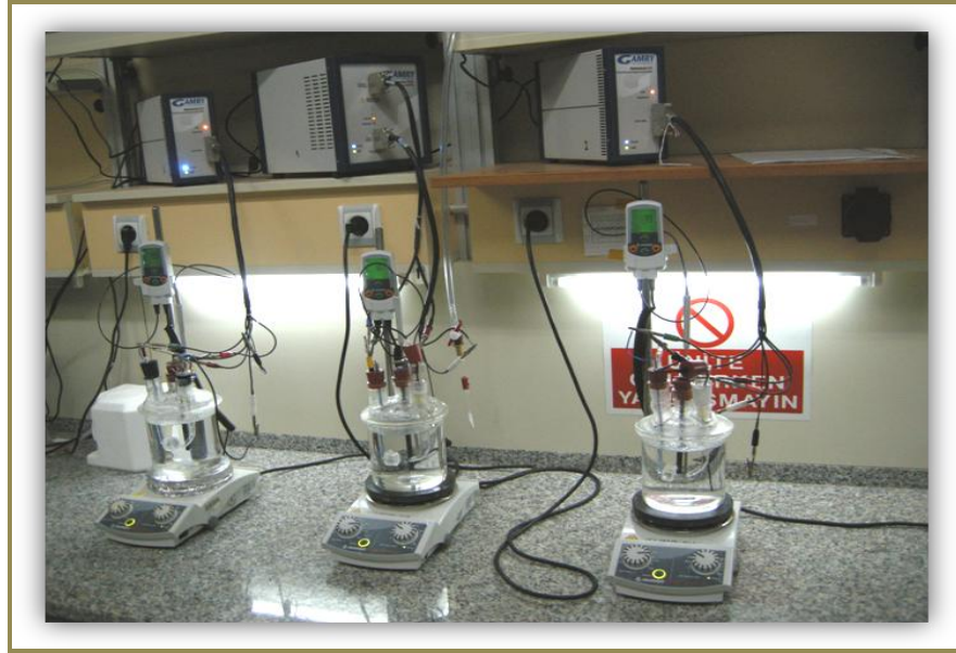
Şekil 3.7 Potansiyostat/Galvanostat – GAMRY (Korozyon Lab., DEÜ)
