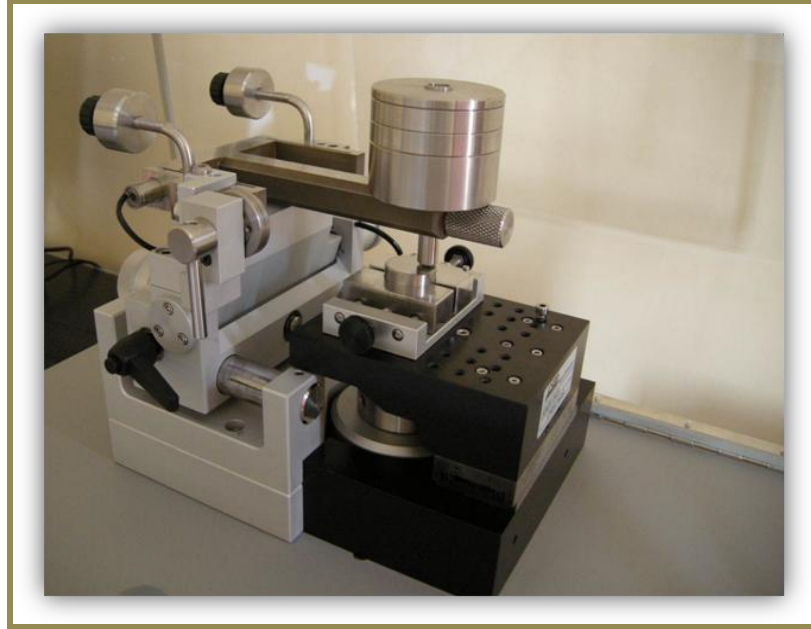
Şekil 3.11 Aşınma test cihazı - CSM Tribometer (Triboloji Lab., DEÜ)
