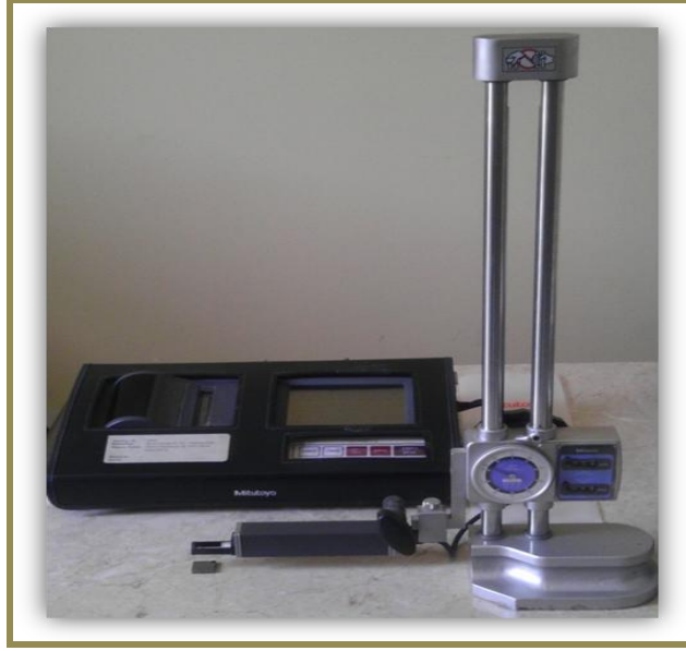
Şekil 3.5 İki boyutlu yüzey profilometresi - MITUTOYO SurfTest-S (Triboloji Lab., DEÜ)
