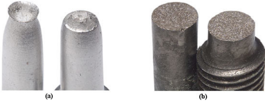
Şekil 3.2 a) Alüminyumun sünek kırılması b) Çeliğin gevrek kırılması (Ay, 2008).
