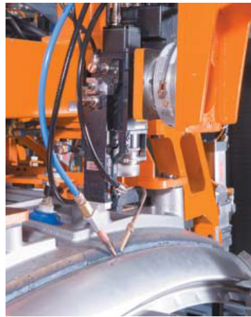
Şekil 1.3 Audi TT otomobilinde alüminyum alaşımlarının ve lazer kaynağının kullanıldığı bölgeler ve otomatik lazer kaynağının uygulanışı.
