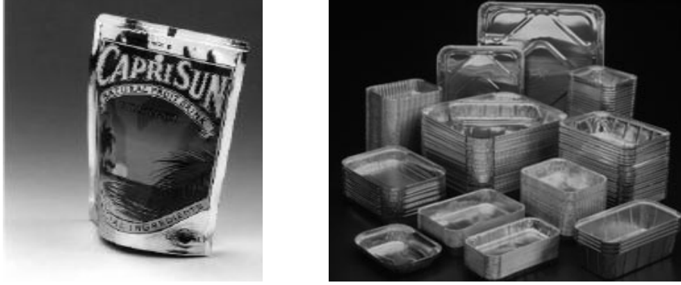
Şekil 2.10 1xxx serisi Al alaşımlarının paketlenme folyoları olarak kullanımı (Kaufman, 2000).
