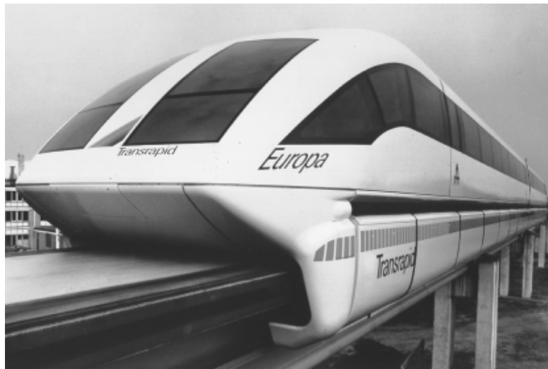
Şekil 2.15 Gövde yapısında 6063 ve 6061 Al alaşımları kullanılan manyetik yükselme (Mag-Lev) treni.
