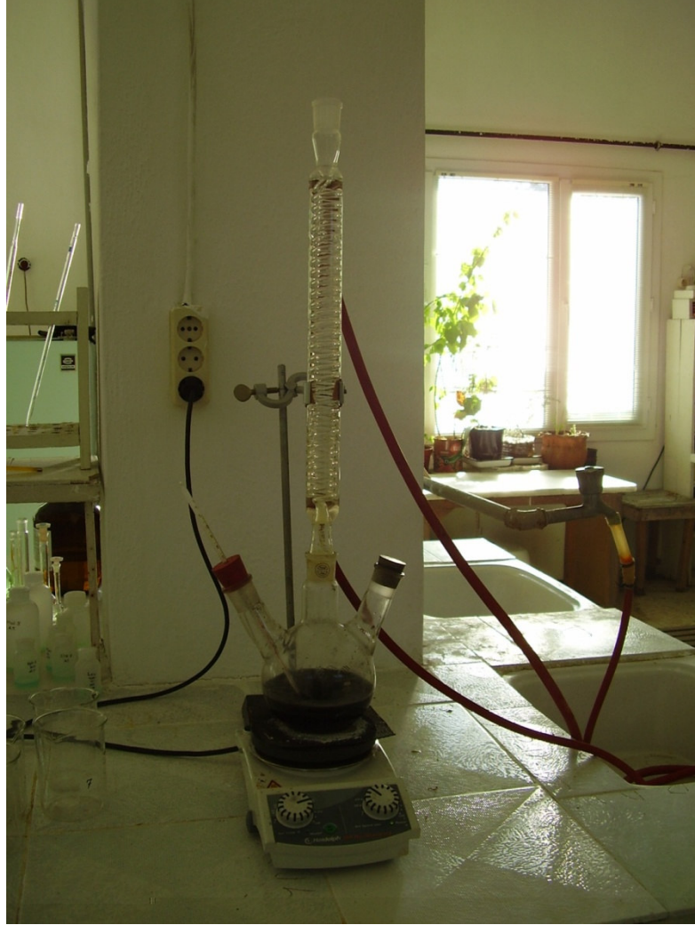
Şekil 3.8 Atmosferik koşullarda liç deneylerinin gerçekleştirildiği deney düzeneği
