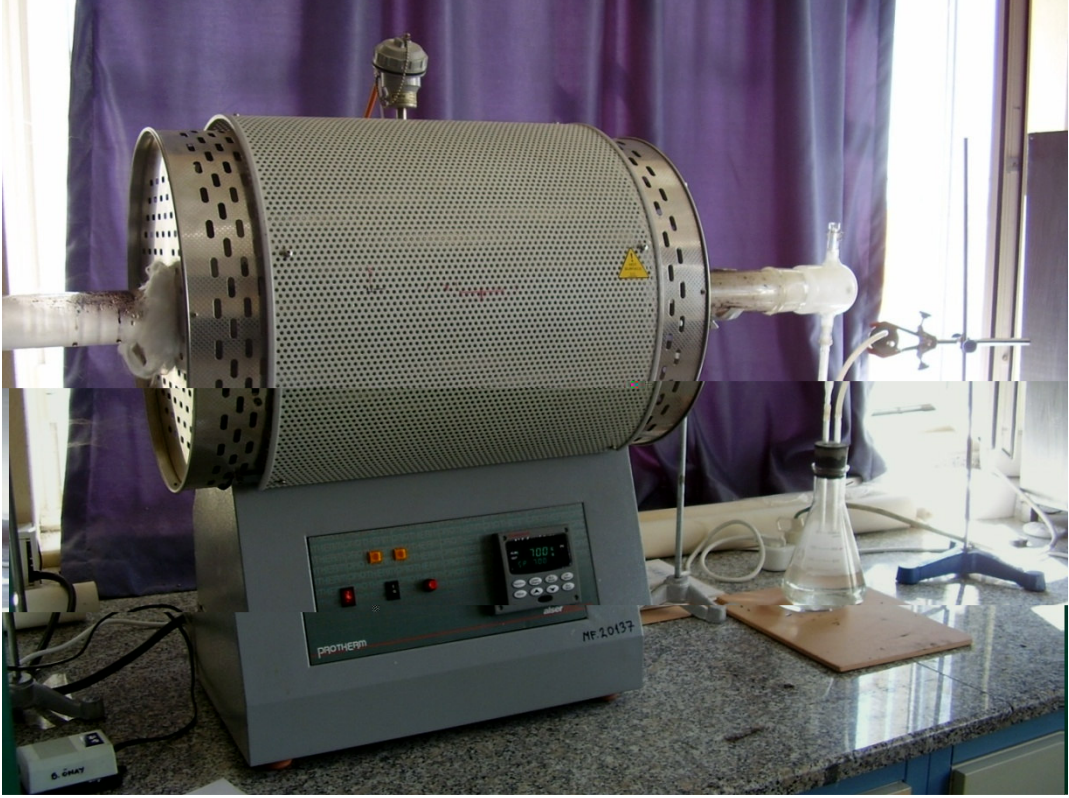
Şekil 3.9 Protherm marka PTF 14750-100 model seramik tüp ısıtım fırını
