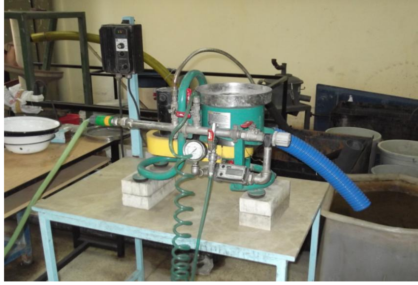
Şekil 5.60 Laboratuvarda kullanılan Knelson konsantratör
