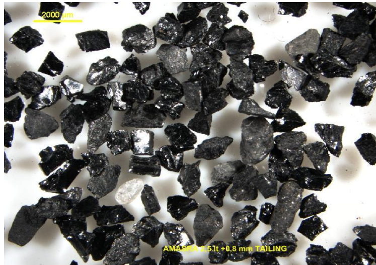
Şekil 5.69 +0,8 mm Amasra artık mikroskop görünümü
