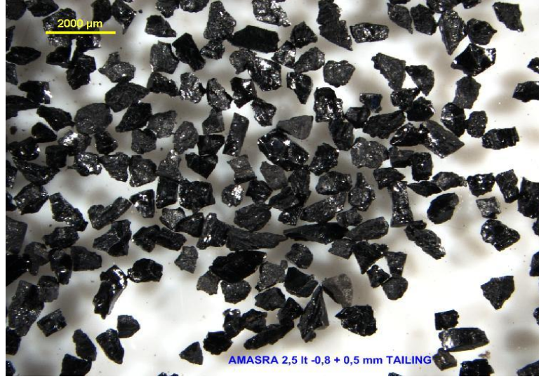
Şekil 5.70 0,8- 0,5 mm Amasra artık mikroskop görünümü
