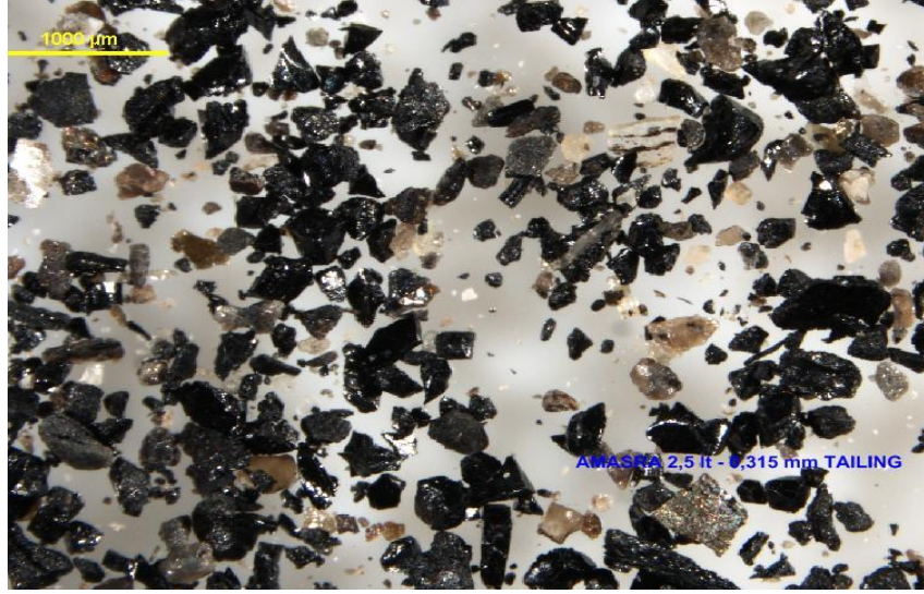
Şekil 5.71 -0,315 mm Amasra artık mikroskop görünümü
