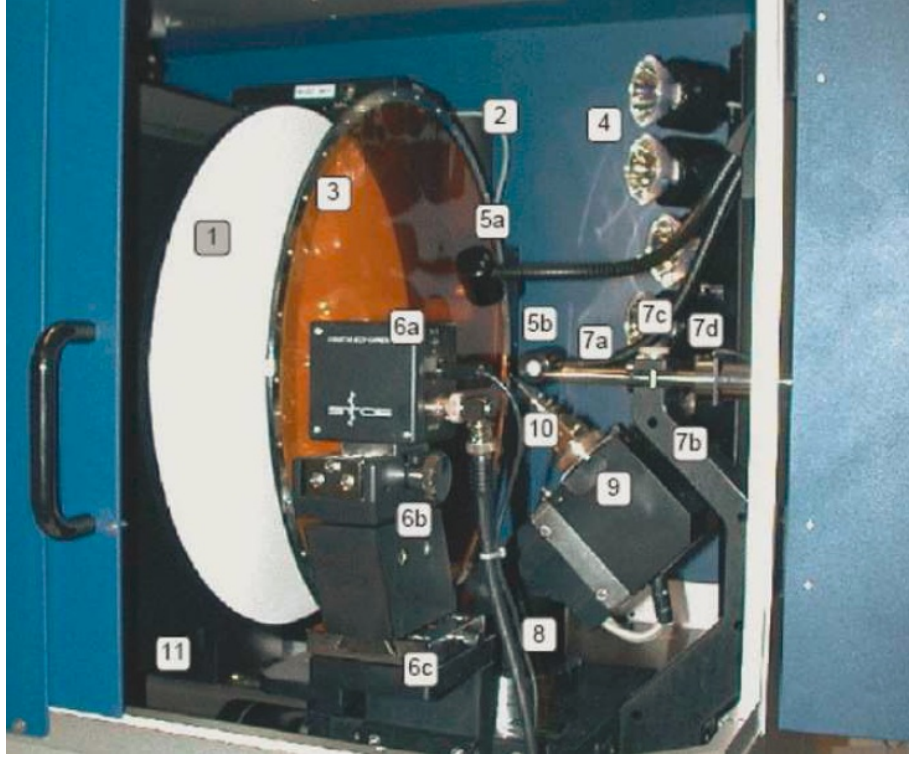
Şekil 2.4 IPDS II kırınım metresinin iç kısmının ayrıntıları: (1) Görüntüleme plakası, (2) Okuyucu kafa, (3) Ana ışın tutucusu, (4) Silici ışıklar, (5a) ve (5b) Örnek aydınlatma lambaları, (6) Video kamera, (6a) Kamerayı hareket ettiren tutucu, (6b) Optik kısım, (7a) Eksenleştirici, (7b) Eksenleştirici tutucusu, (7c) Ek sabitleme vidası, (7d) Güvenlik düğmesi, (8) \omega dönü eksenini, (9) \phi eksenini-örneği döndüren eğik eksen, (10) Gonyometre başlığı, (11) Görüntüleme plakası taşıyıcısı.
