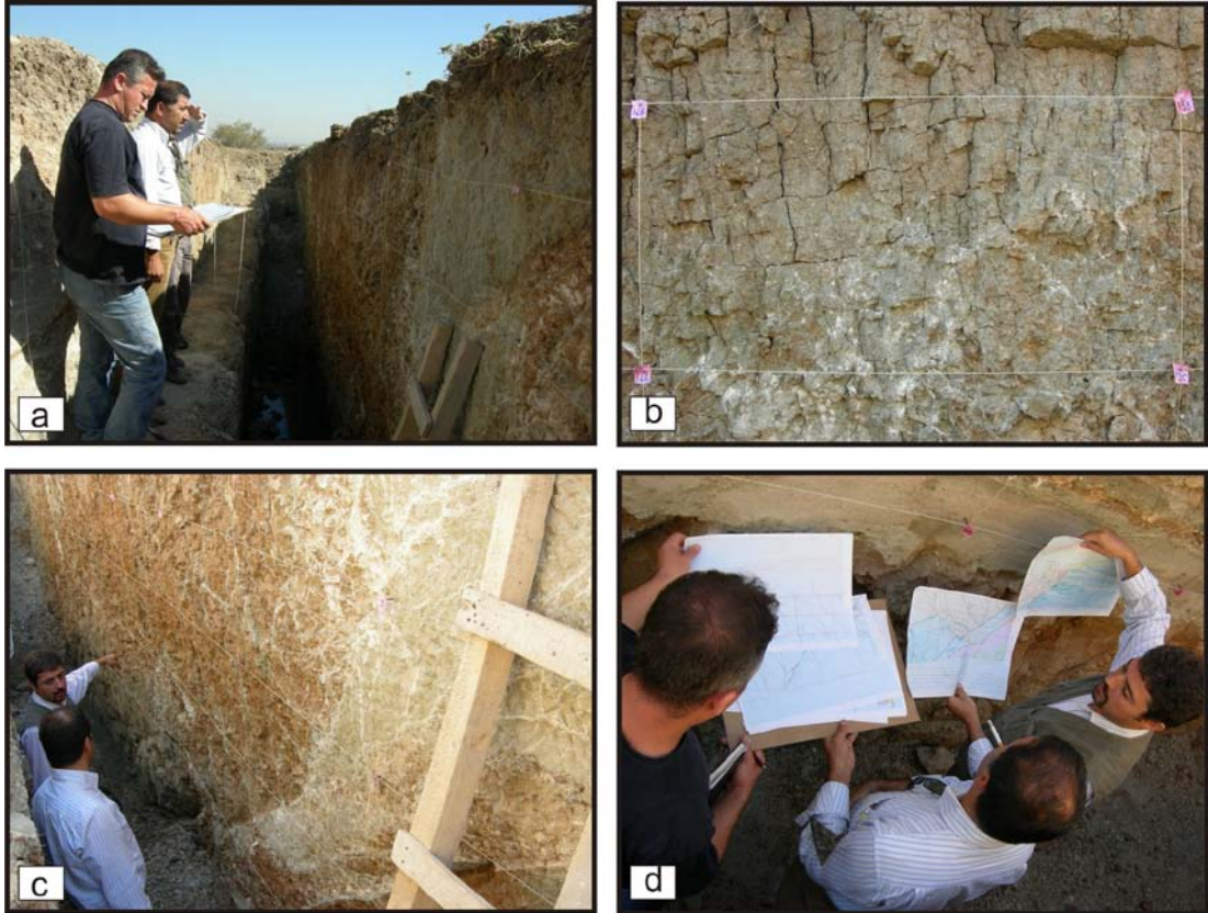
Şekil 1.11 Hendek içerisindeki a-b) karelaj ve etiketleme modelini c-d) logların çizim ve yorumlanması çalışmalarını gösteren fotoğraflar.
