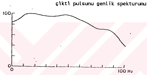
Şekil 4.11. Veri-İşlem sonrası maxipuls sinyali ve spektrumu 2
