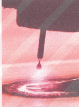
Şekil 2.8. Sinerjik darbeli akım üreteci ile elde edilen bir damla
