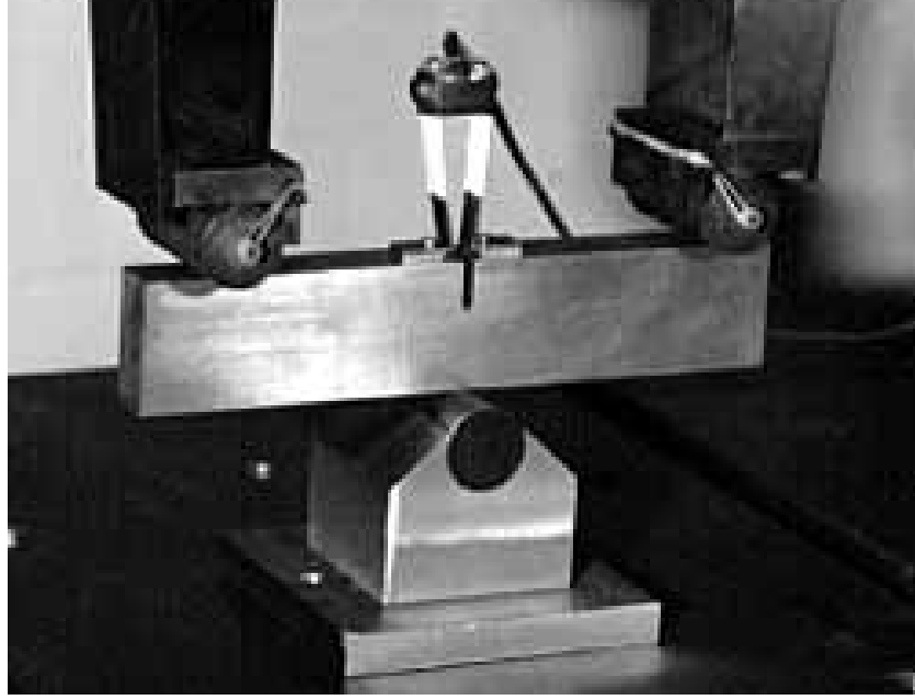
Şekil 4.2. Üç noktadan eğme deneyi ile çatlak ağzı açılma deplasmanı ölçümü
