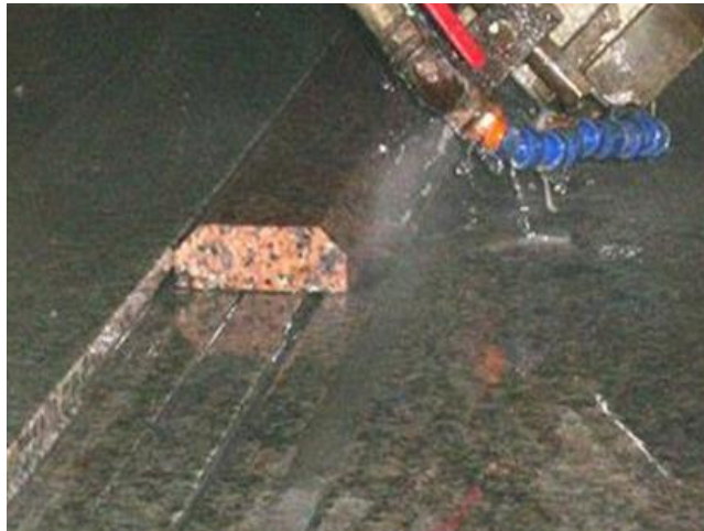
Şekil 3.18 Yan kesme makinesi ve kesim işleminin yapılışı
