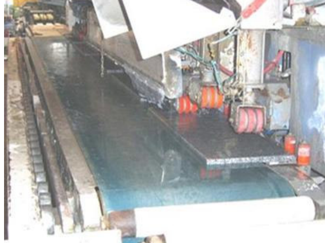
Şekil 3.19 Alın cila makinesi ve cilalama işleminin yapılışı
