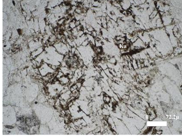
Şekil 4.101 Plajiyoklas minerallerinde gözlenen kaolinleşmenin tek nikol görünümü
