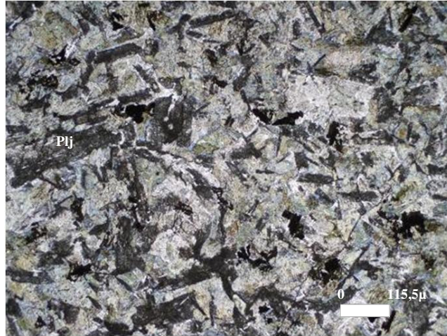
Şekil 4.238 Plajiyoklas minerallerindeki alterasyonun tek nikol görünümü
