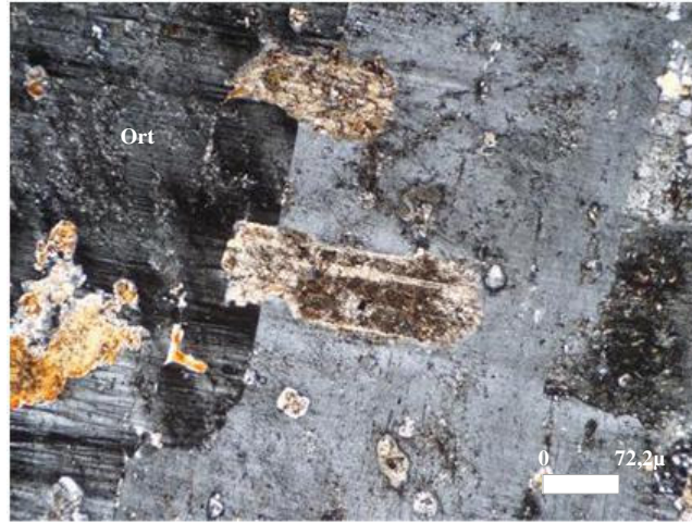
Şekil 4.112 Ortoklas mineralleri içinde bulunan katı kapamaların çift nikol görünümü
