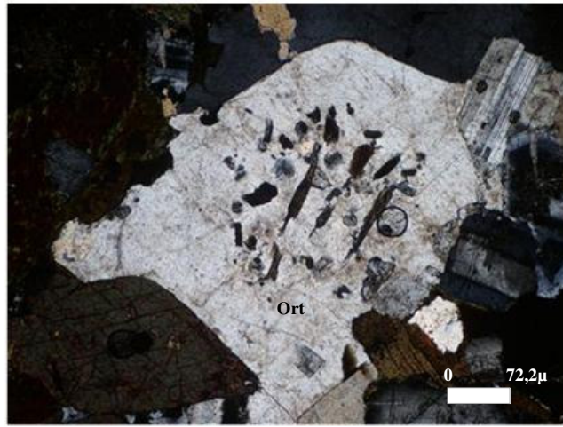
Şekil 4.163 Ortoklas minerali içindeki katı kapanımların çift nikol görünümü
