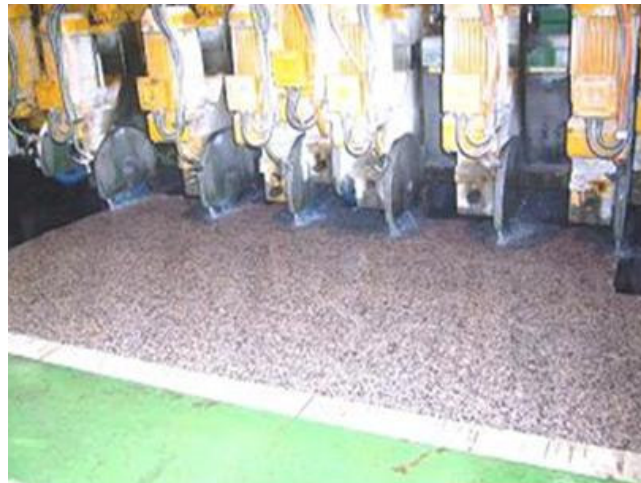
Şekil 3.20 Çoklu kesme makinesi ve kesim işleminin yapılışı
