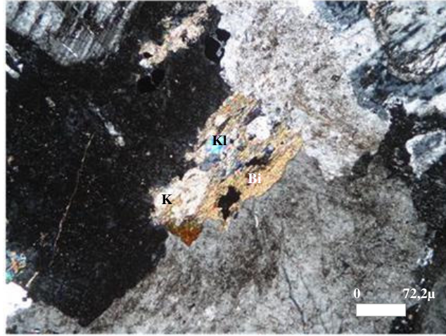
Şekil 4.49 Biyotit minerallerinde gözlenen kloritleşme ve kalsitleşmenin çift nikol görünümü
