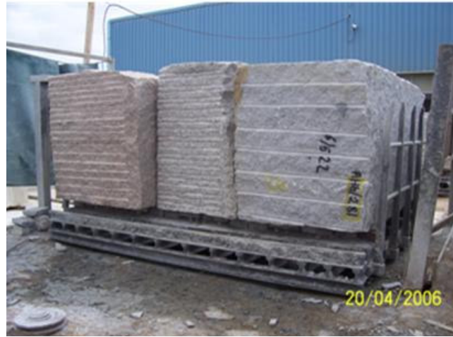
Şekil 3.7 Blokların katrak arabasına yerleştirilmesi
