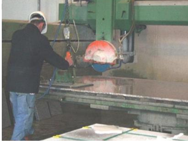
Şekil 3.17 Köprü kesme makinesi ve kesim işleminin yapılışı
