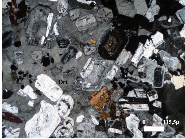
Şekil 4.139 Ortoklas minerali içindeki katı kapanımların çift nikol görünümü
