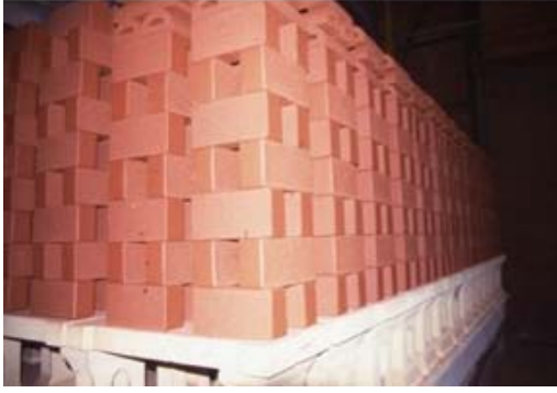
Şekil 3.102 Keramik eleman stoklama ve paketleme (Işıklar tuğla, 2007).
