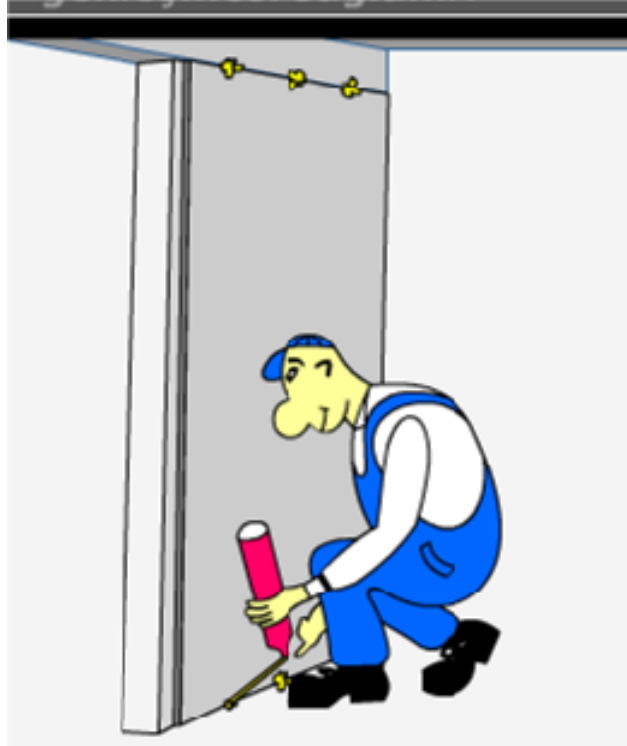
Şekil 3.39 Fibercement kompozit panel uygulama detayı (Duvarpan, 2008).
