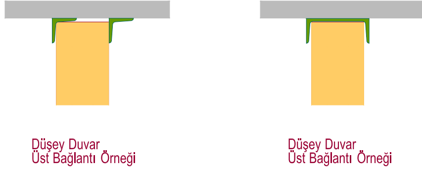
Şekil 3.16 Gazbeton Birleşim Detayı (www.akg-gazbeton.com.tr).
