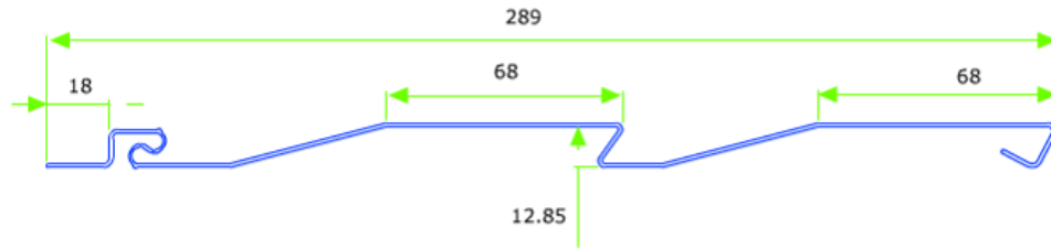
Şekil 3.62 Vinil siding eleman boyutları (Paksiding, 2008).
