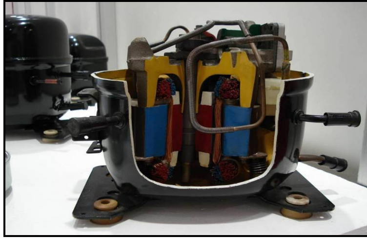
Şekil 2.14 Pistonlu kompresörün iç detayları (Yılmaz, 2007)
