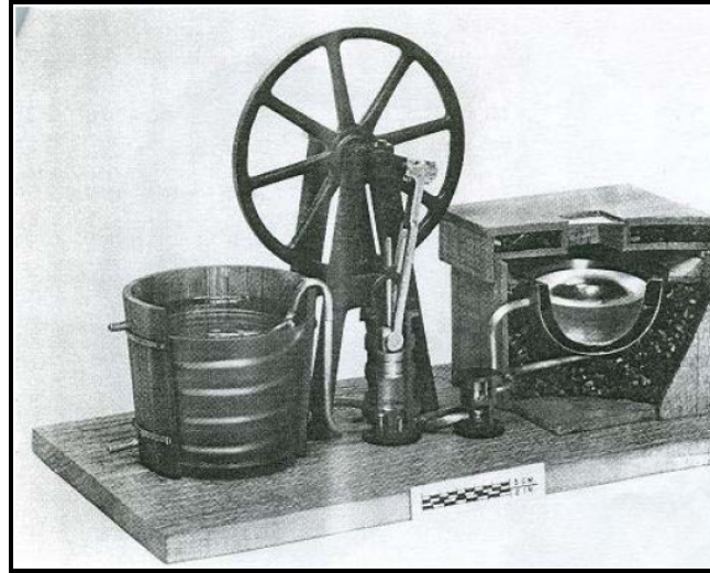
Şekil 1.3 J. Hague tarafından gerçeğe dönüştürülen Perkins Soğutucusu (History of Refrigeration, bt.).
