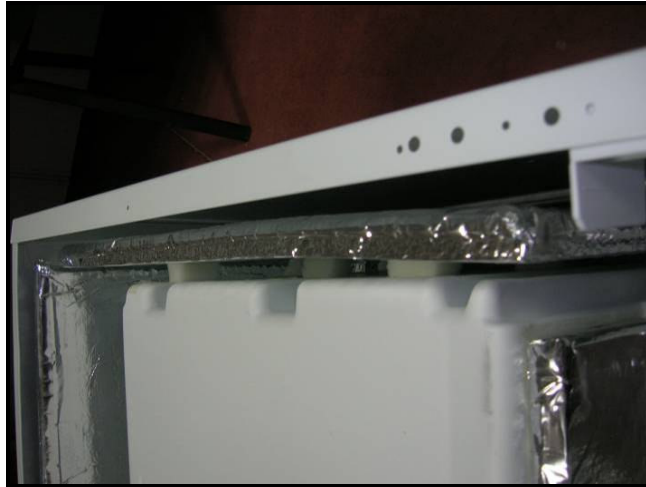
Şekil 6.7 2 numaralı VIP'in sac ve plastik arasındaki yerleşimi
