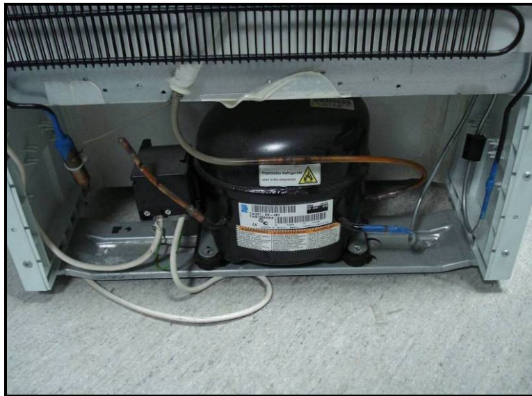
Şekil 2.15 Pistonlu kompresörün, dondurucu arka alt kısmında yer alan yatağındaki görüntüsü ve diğer elemanlarla olan bağlantıları (Yılmaz, 2007)
