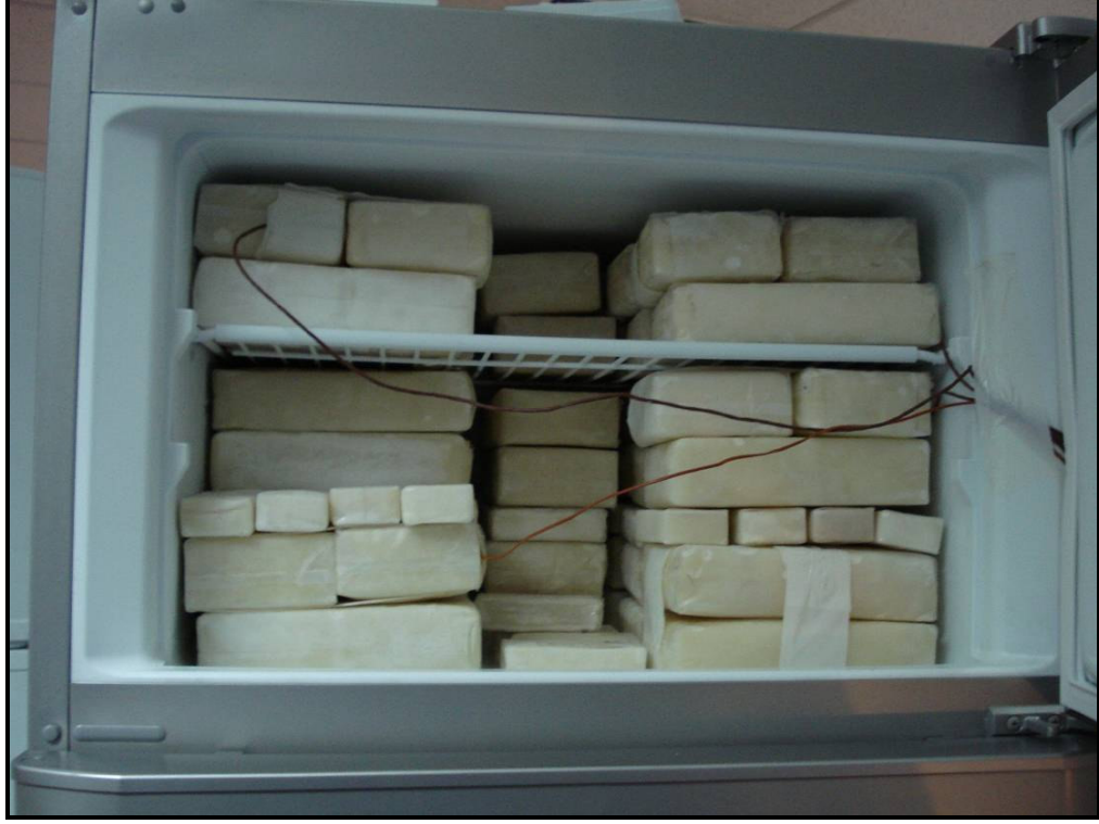
Şekil 3.15 Enerji ölçümü testlerinde kullanılan deney ve M paketleri (Yılmaz, 2007)
