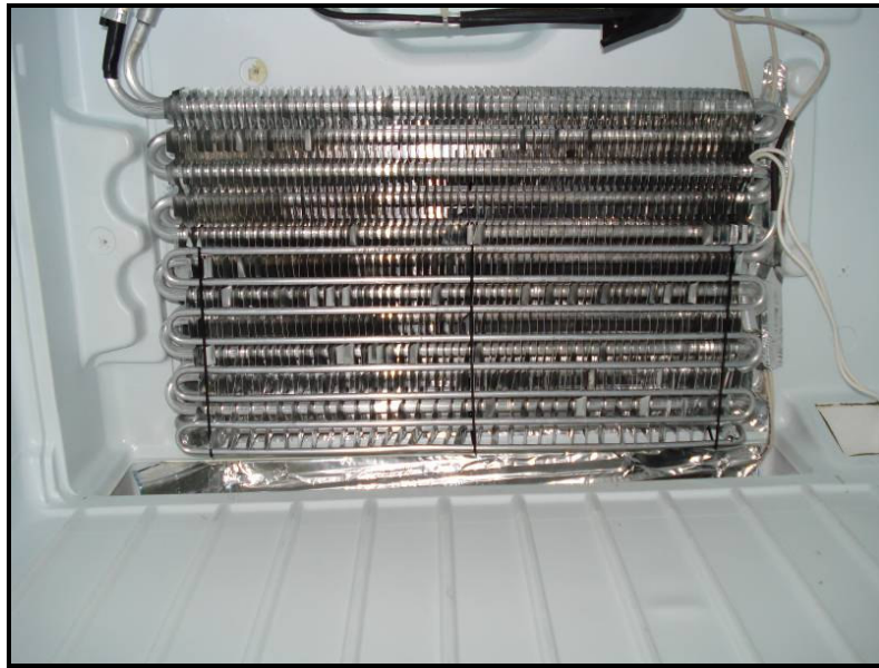
Şekil 2.22 Kanat boru tipi evaporatör (Yılmaz, 2007)
