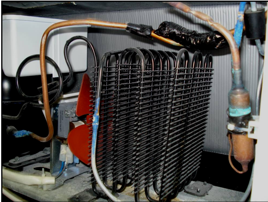
Şekil 2.17 Zorlanmış taşınımlı hava soğutmalı kondanserin ve fanının kompresör boşluğundaki yerleşimi (Yılmaz, 2007)
