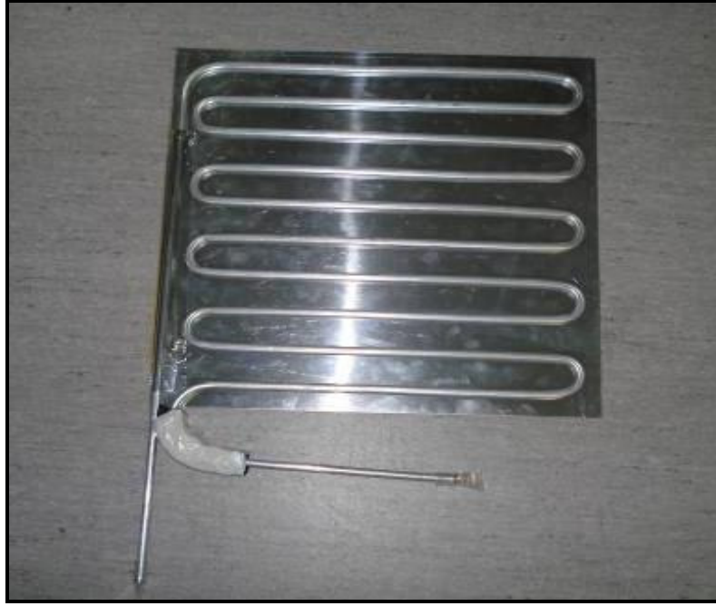
Şekil 2.21 Levha boru tipi evaporatör (Yılmaz, 2007)
