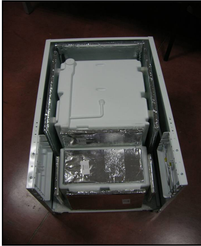
Şekil 6.9 PU basılmaya hazır dondurucu (arka panel yok iken)
