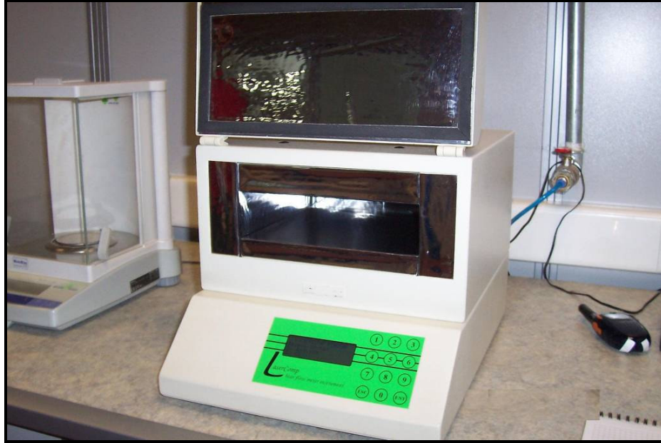
Şekil 4.11 Çalışmada kullanılan ısı iletim katsayısı ölçüm cihazı (Yılmaz, 2007)
