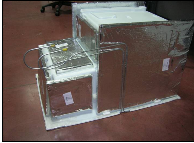
Şekil 6.6 2 ve 4 numaralı VIP'lerin uygulama detayı
