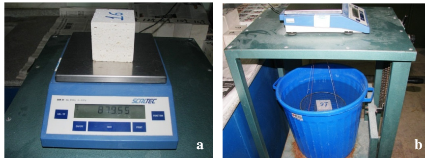
Şekil 1.6 Arşimet terazisi düzeneği, traverten numunesini su içinde ve havada doymun tartımı.
