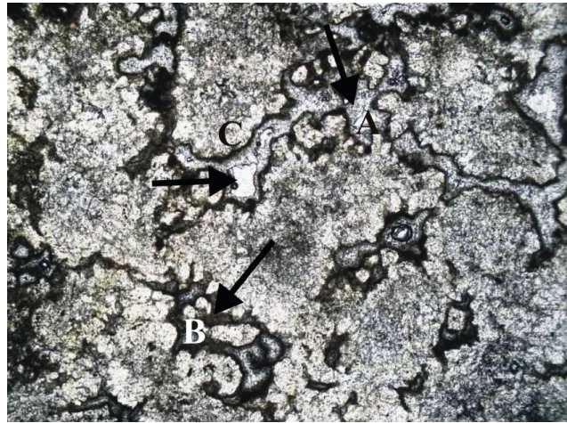
Şekil 2.29 Algal spar küme çatı arası boşluklar. “Medium” tipi traverten 1. basamak 4B no’ lu örnek; A. Algal spar küme çatısı arası spar kalsit boşluk dolgusu, B. mikrobiyal mikrit boşluk dolgusu C. boş gözenek (x10).
