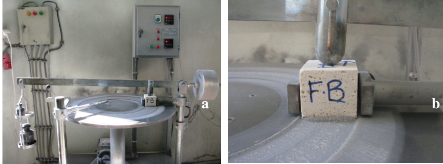
Şekil 1.9 Böhme aşınma kaybı deney aleti (a) ve deneyinin uygulaması (b).
