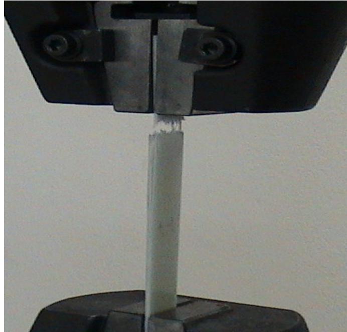
Şekil 4.13 0° numune için kopma deneyi sonucu görünümü
