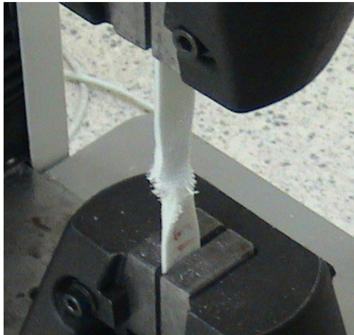
Şekil 4.14 45° numune için kopma deneyi sonucu görünümü
