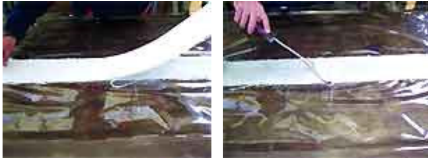
Şekil 4.8 Elle yatırma yöntemi ile cam/epoksi kompozit malzeme üretimi
