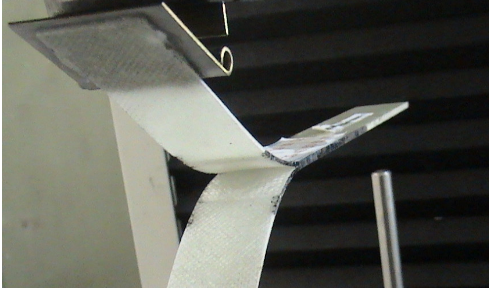
Şekil 4.22 Örgülü Cam/Epoksi DCB numunesinin delaminasyona maruz kalan ara yüzeyi
