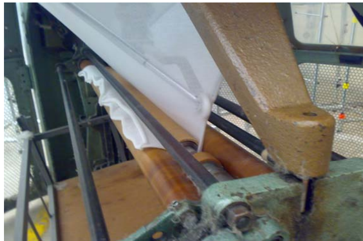
Şekil 2.18 Monarch-Vanguard yuvarlak örme makinesindeki kumaş çekim bölgesi
