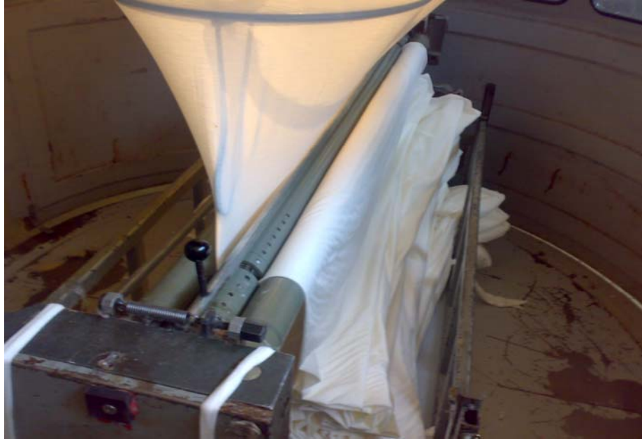
Şekil 2.16 Mayer&Cie yuvarlak örme makinesindeki kumaş çekim bölgesi
