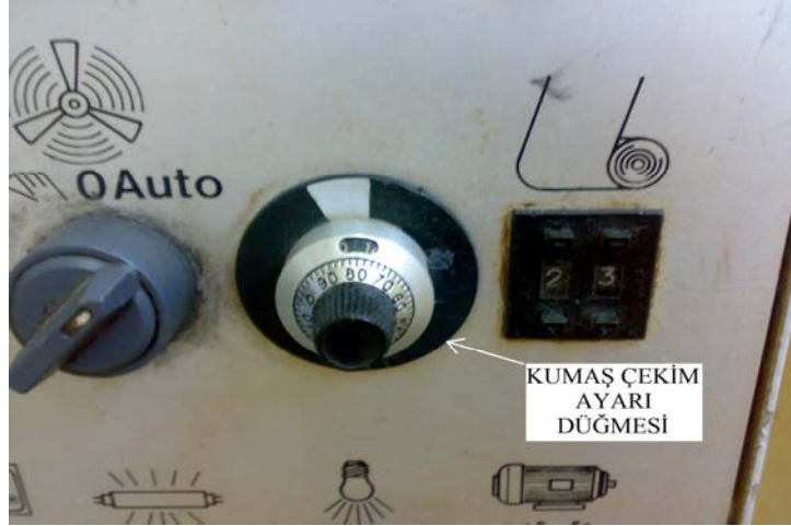
Şekil 2.15 Mayer&Cie yuvarlak örme makinesindeki kumaş çekim ayarı düğmesi
