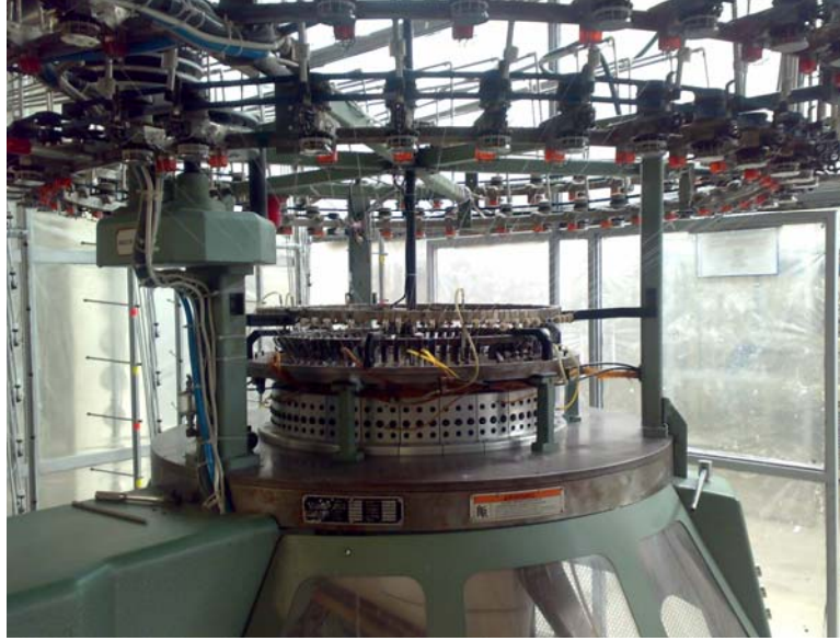
Şekil 2.5 Tek lakost numunelerinin örüldüğü Monarch-Vanguard marka tek yataklı yuvarlak örme makinesi
