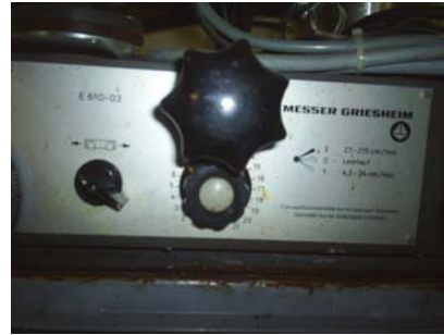
Şekil 5.13 Kaynak arabasının hız ayar sistemi.
