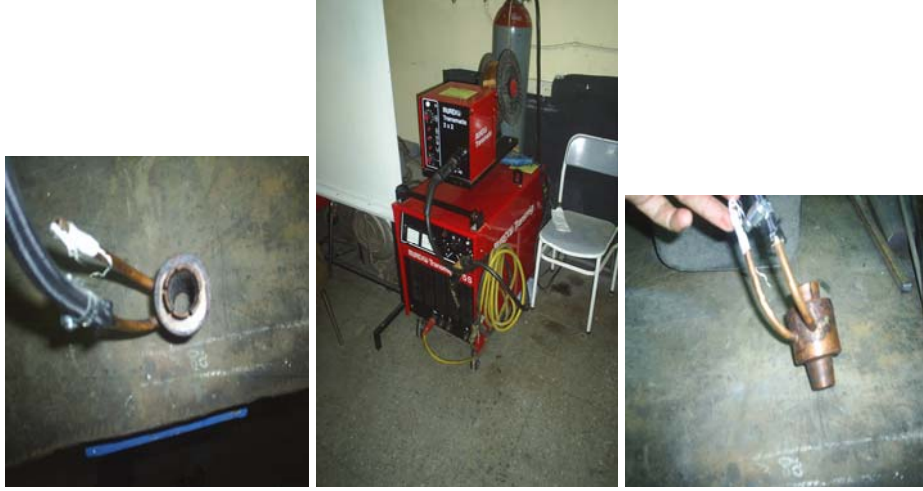
Şekil 5.9 Nozul soğutma aparatı ve MIG/MAG kaynak makinası.
