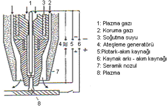
Şekil 3.10 Mikroplazma kaynağı.
