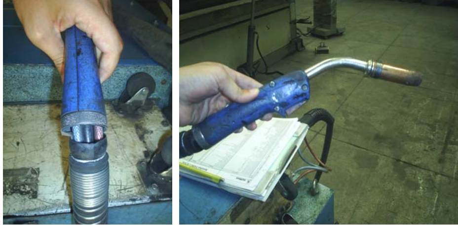
Şekil 5.15 Su soğutmalı torç içinden geçen soğuk-sıcak su hortumları ve torcun genel görüntüsü.
