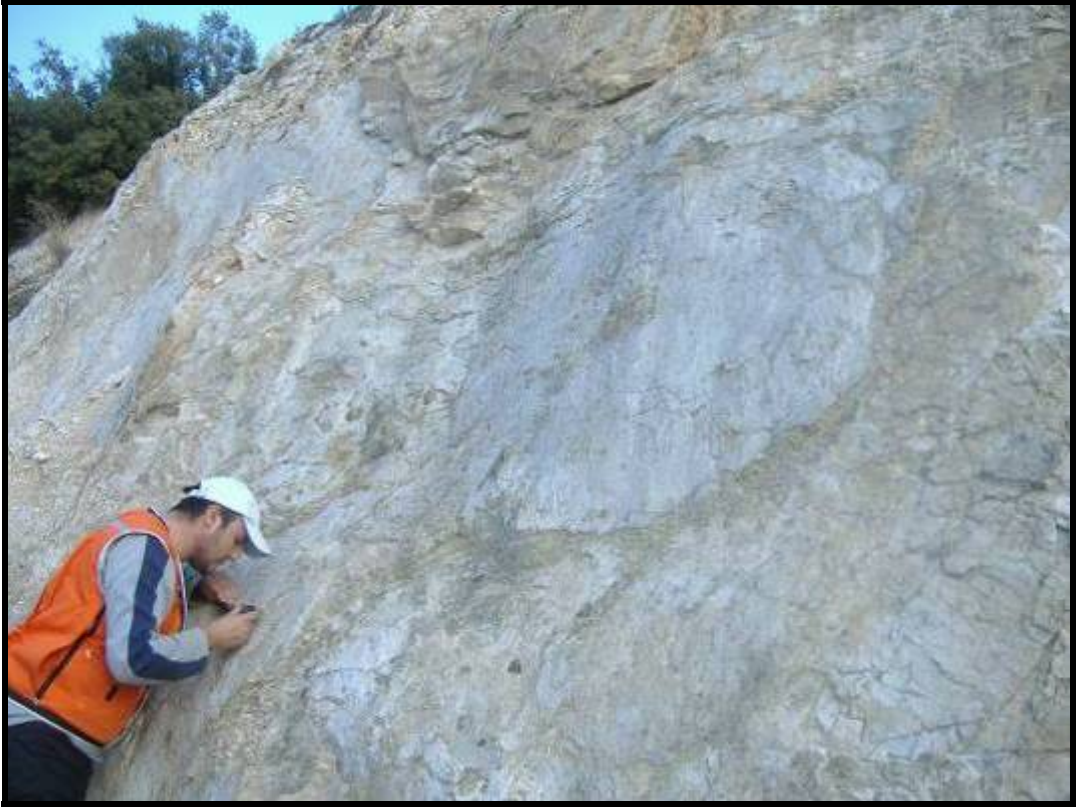
Şekil 3.4 Saraycık köyünün 2km GB'ında yer alan, Demirci havzasını meydana getiren, graben kenarı ana fay'a ait kayma düzlemi (Fay düzlemi ölçümü: K63D / 62KB) (K: 0631536E / 4294617N).
