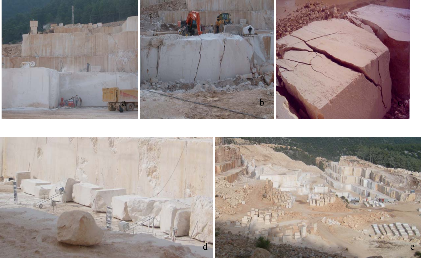
Şekil 4.1 Açık işletmede limra mermer üretimi; a) Limra mermerlerinin elmas tel ile kesilmesi, b), c) Kesilen kütleinin devrilmesi, d) Blokların sayalama işlemi ile yeniden boyutlandırılması, e) Blokların blok stok sahasına taşınması.
