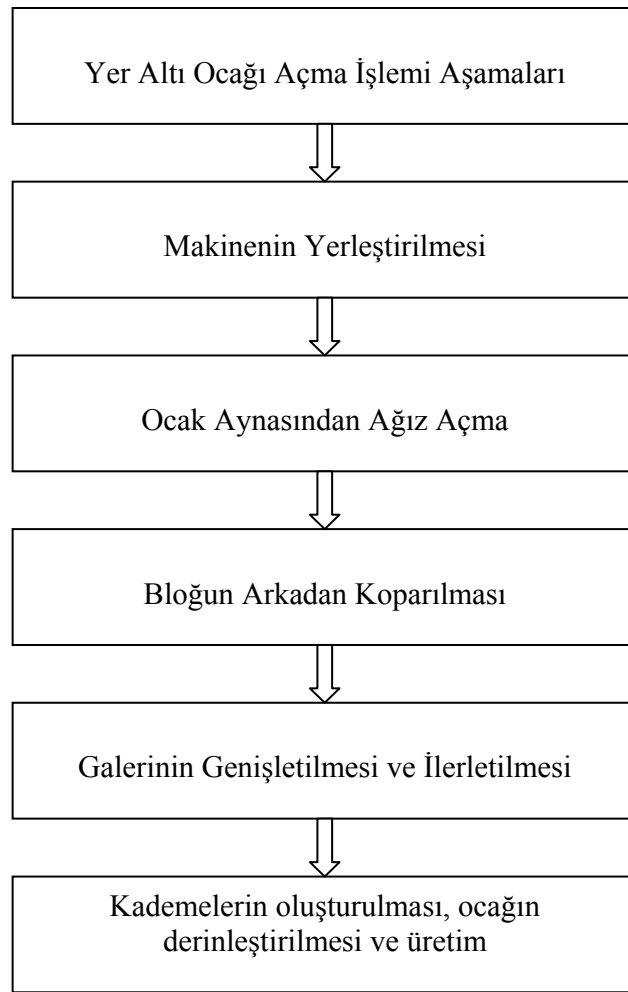
Şekil 4.2 Yer altı ocağı açma işlemi aşamaları.
