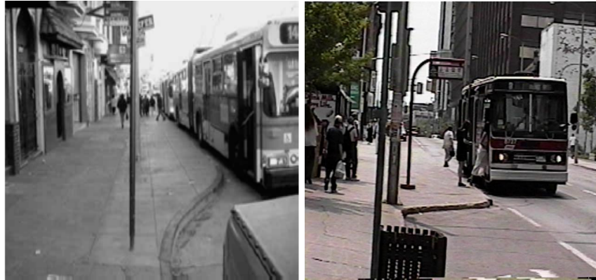
Şekil 4.26 Dünyadan bazı ters cepli durak uygulama örnekleri (TCRP 2001).
