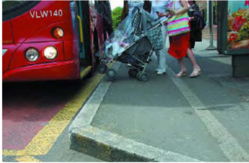
Şekil 3.1 Düşük zeminli otobüsün faydası (Transport for london, 2006).
