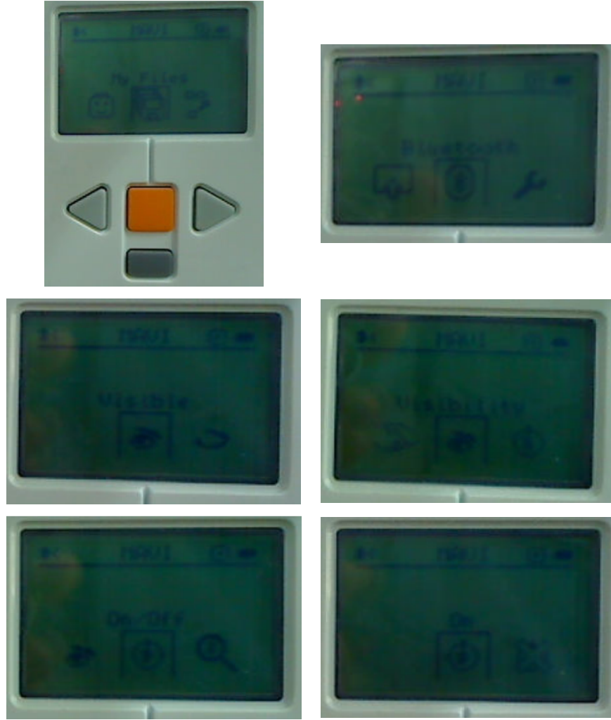
Şekil 5.2 Akıllı tuğlanın genel menüsü, kontrol düğmeleri ve bluetooth ayarları
