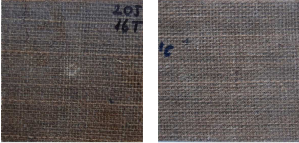
Şekil 4.51 20J Enerji uygulanan 16 tabaka jüt numunesine ait hasar fotoğrafı
