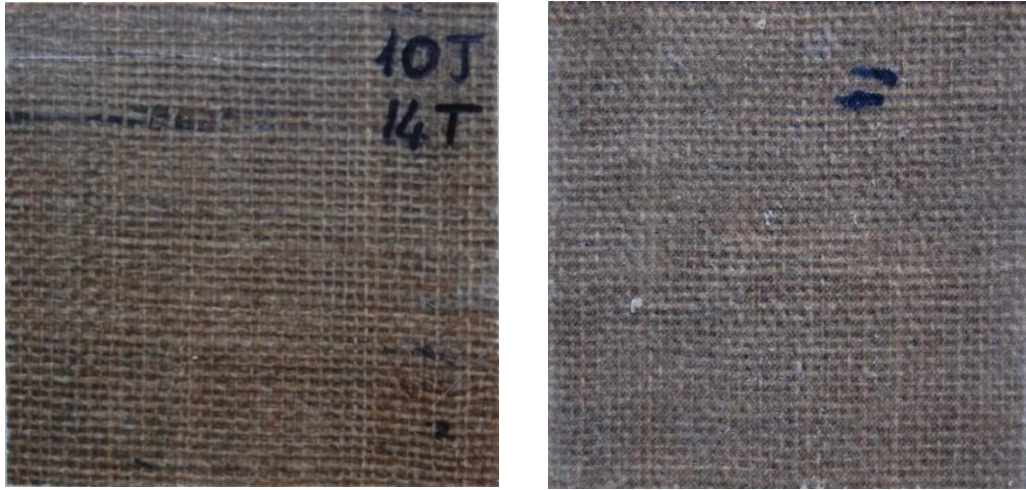
Şekil 4.33 10J Enerji uygulanan 14 tabaka jüt numunesine ait hasar fotoğrafı
