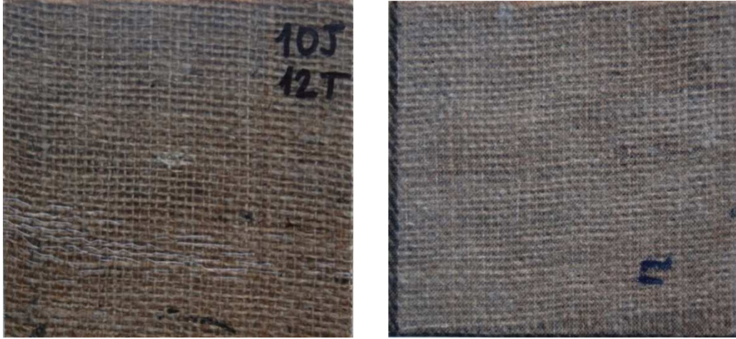
Şekil 4.21 10J Enerji uygulanan 12 tabaka jüt numunesine ait hasar fotoğrafı
