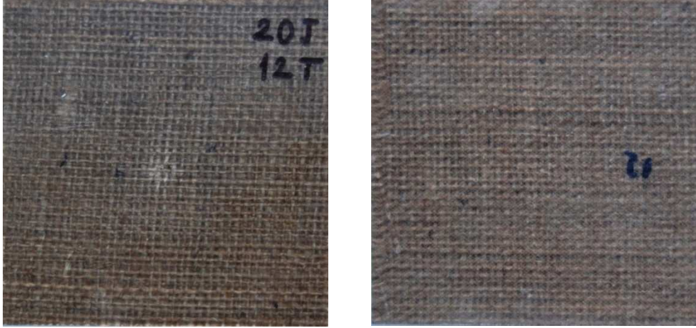
Şekil 4.24 20J Enerji uygulanan 12 tabaka jüt numunesine ait hasar fotoğrafı
