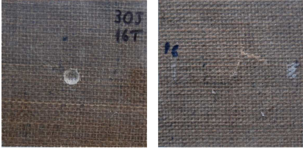
Şekil 4.54 30J Enerji uygulanan 16 tabaka jüt numunesine ait hasar fotoğrafı
