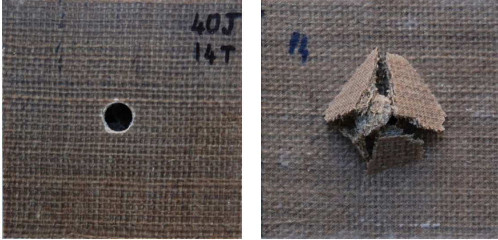
Şekil 4.45 40J Enerji uygulanan 14 tabaka jüt numunesine ait hasar fotoğrafı
