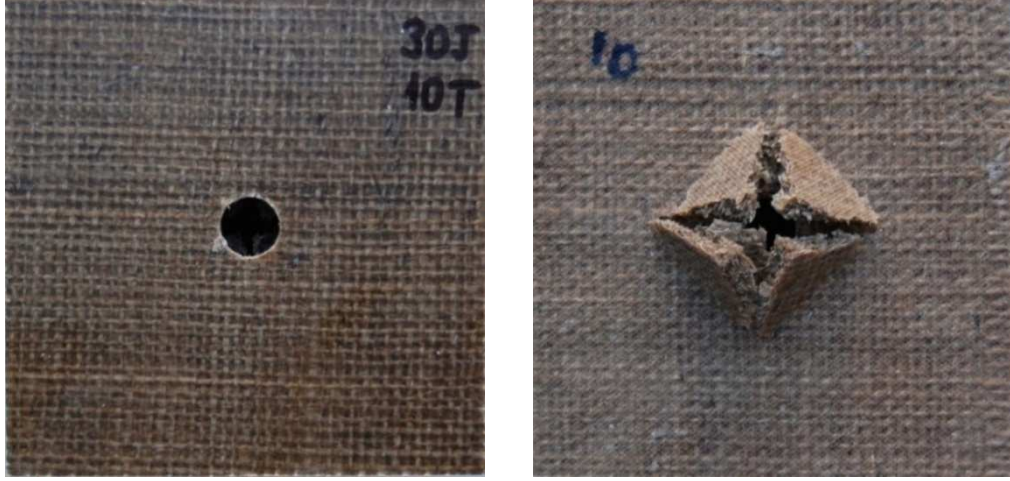
Şekil 4.18 30J Enerji uygulanan 10 tabaka jüt numunesine ait hasar fotoğrafı
