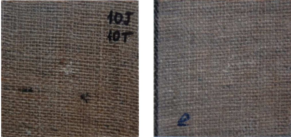
Şekil 4.12 10J Enerji uygulanan 10 tabaka jüt numunesine ait hasar fotoğrafı
