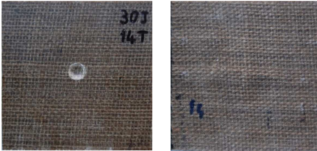
Şekil 4.39 30J Enerji uygulanan 14 tabaka jüt numunesine ait hasar fotoğrafı
