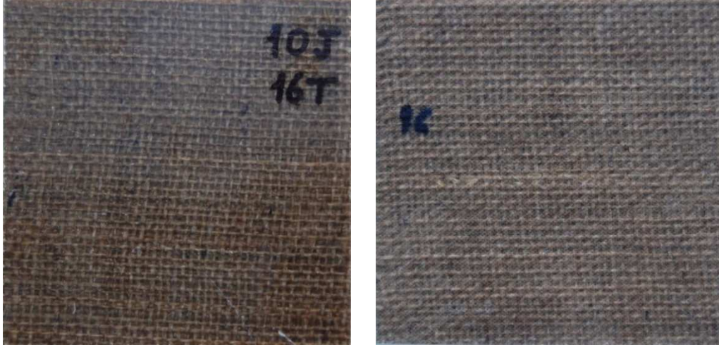
Şekil 4.48 10J Enerji uygulanan 16 tabaka jüt numunesine ait hasar fotoğrafı
