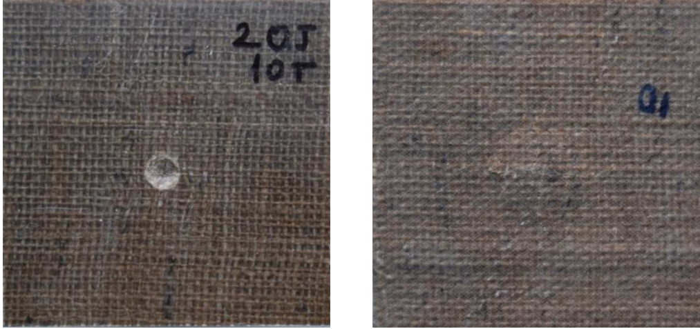
Şekil 4.15 20J Enerji uygulanan 10 tabaka jüt numunesine ait hasar fotoğrafı
