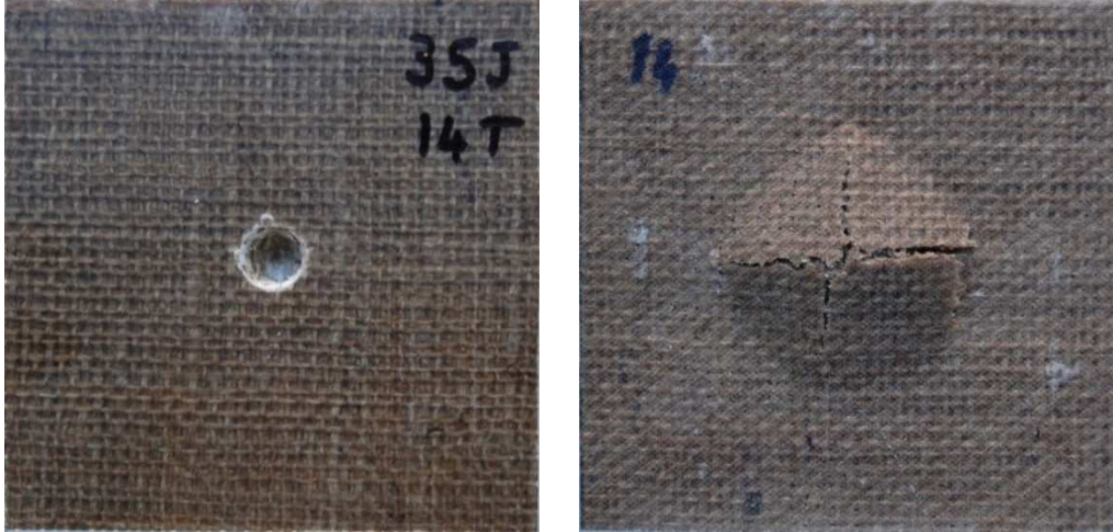
Şekil 4.42 35J Enerji uygulanan 14 tabaka jüt numunesine ait hasar fotoğrafı
