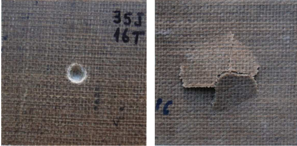
Şekil 4.57 35J Enerji uygulanan 16 tabaka jüt numunesine ait hasar fotoğrafı
