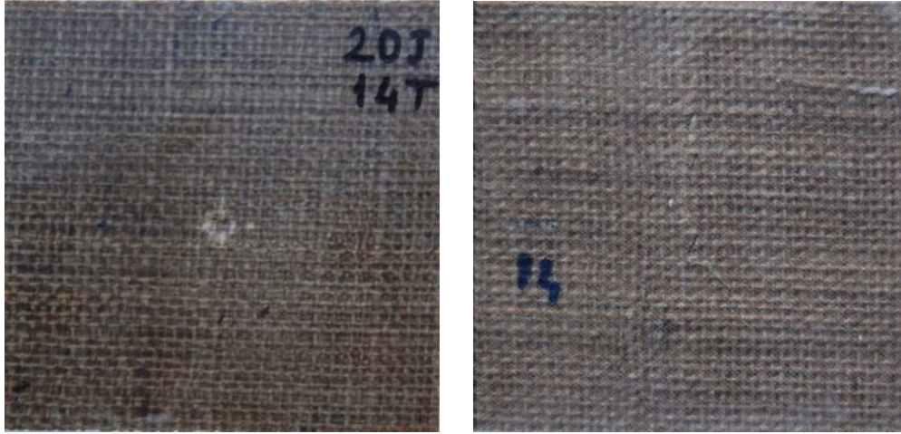
Şekil 4.36 20J Enerji uygulanan 14 tabaka jüt numunesine ait hasar fotoğrafı
