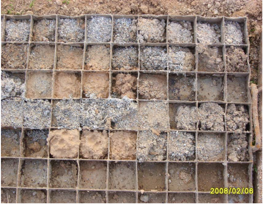
Şekil 3.6 Sondaj çalışma sırasında çakıltaşı biriminden çıkan numunelerin görünümü verilemiştir.
