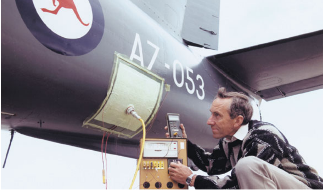
Şekil 2.4 Bir uçak gövdesinin yama ile onarımı (www.dsto.defence.gov.au)
