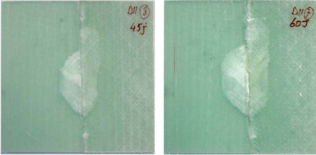
İnfüzyon ile onarım 45J
