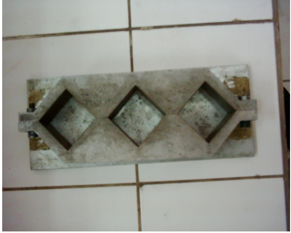
Şekil 4.2 50mmx50mmx50mm ölçülerinde numune alma kalıbı
