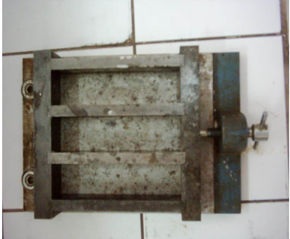
Şekil 4.1 40 mm x 40 mm x 160 mm ölçülerinde numune alma kabı
