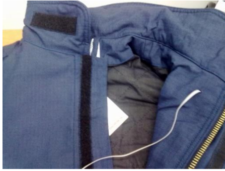
Şekil 4.10 İç sıcaklık sensörünün bağlandığı kablo
