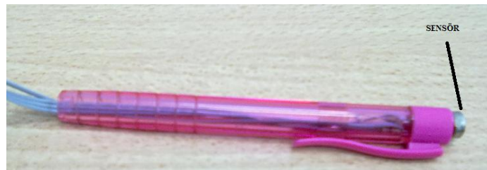
Şekil 4.13 Dış sıcaklık sensörünün kaleme bağlantısı
