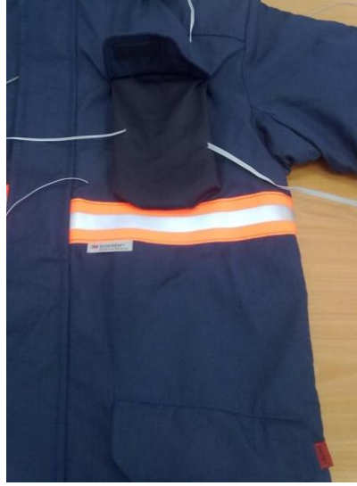
Şekil 4.9 ışık sensörü, çevre sıcaklık sensörü, dış sıcaklık sensörü ve kulaklık yerleşim noktalarına iletilen kablolar
