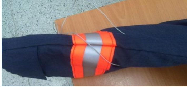
Şekil 4.8 Sol LED şeritlere kablo iletimi
