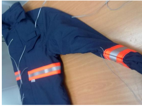
Şekil 4.6 Sağ dokunma algı düğmelerine kablo iletimi
