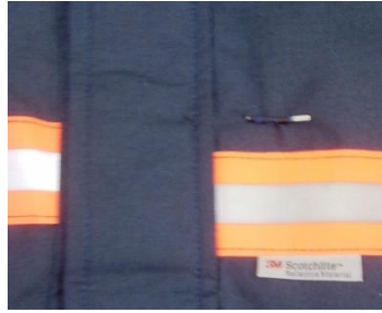
Şekil 4.11 Çevre sıcaklığı sensörünün cekete dikilmesi
