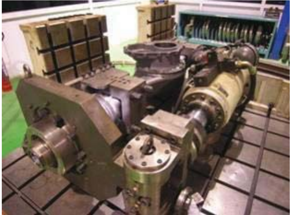
Şekil 3.20 Yatay yorulma testine bağlanmış saç diferansiyel kovanı
