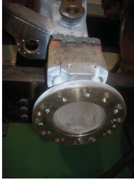
Şekil 1.20 Döküm diferansiyel kovani
