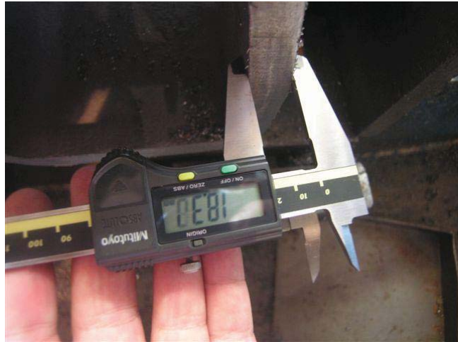
Şekil 2.2 Döküm diferansiyel kovanı gövde et kalınlığı
