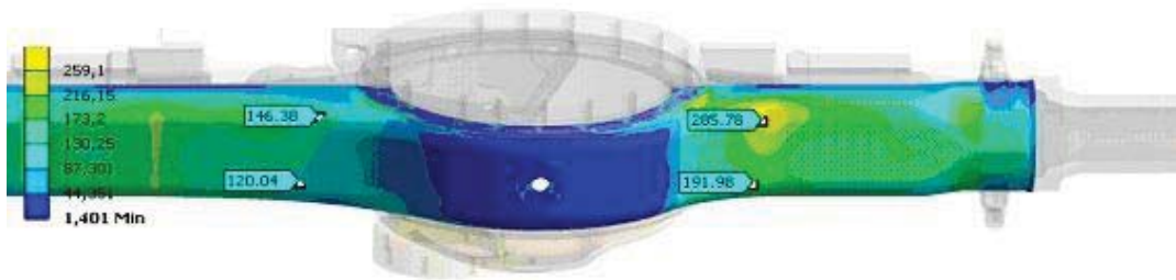
Şekil 3.7 Alt gövde yarımında meydana gelen eşdeğer gerilmeler
