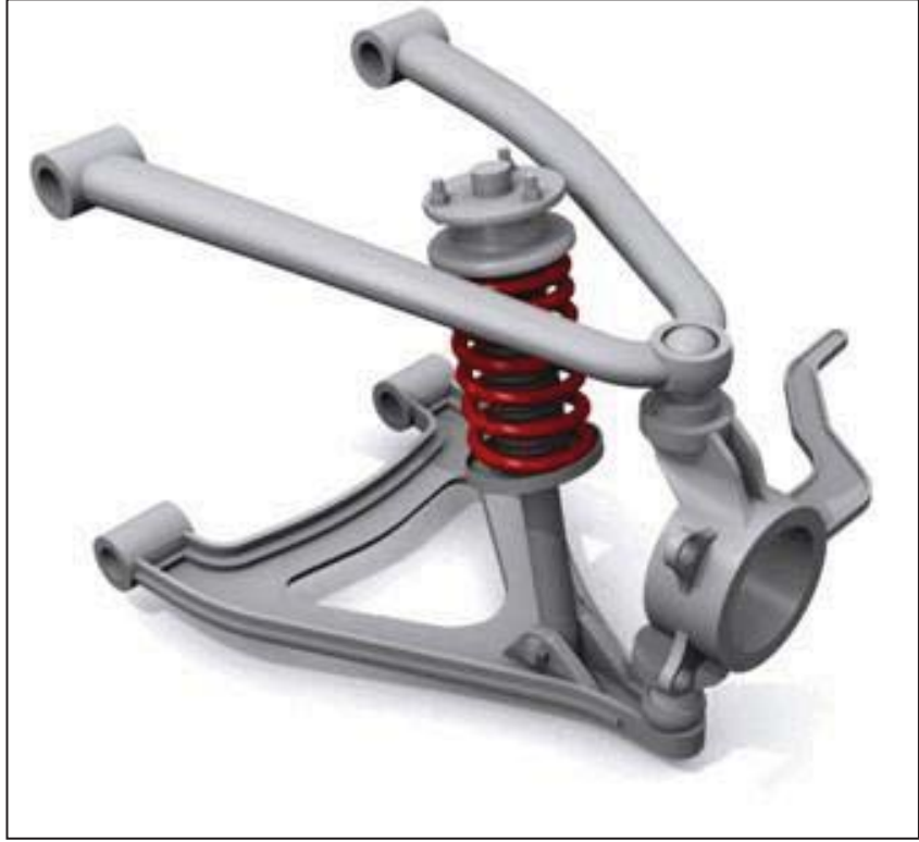
Şekil 1.1 Çift enine yön vericili askı sistemi (Double Wishbone)
