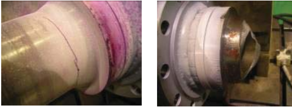
Şekil 3.21 Yatay yorulma testi test sonuçları
