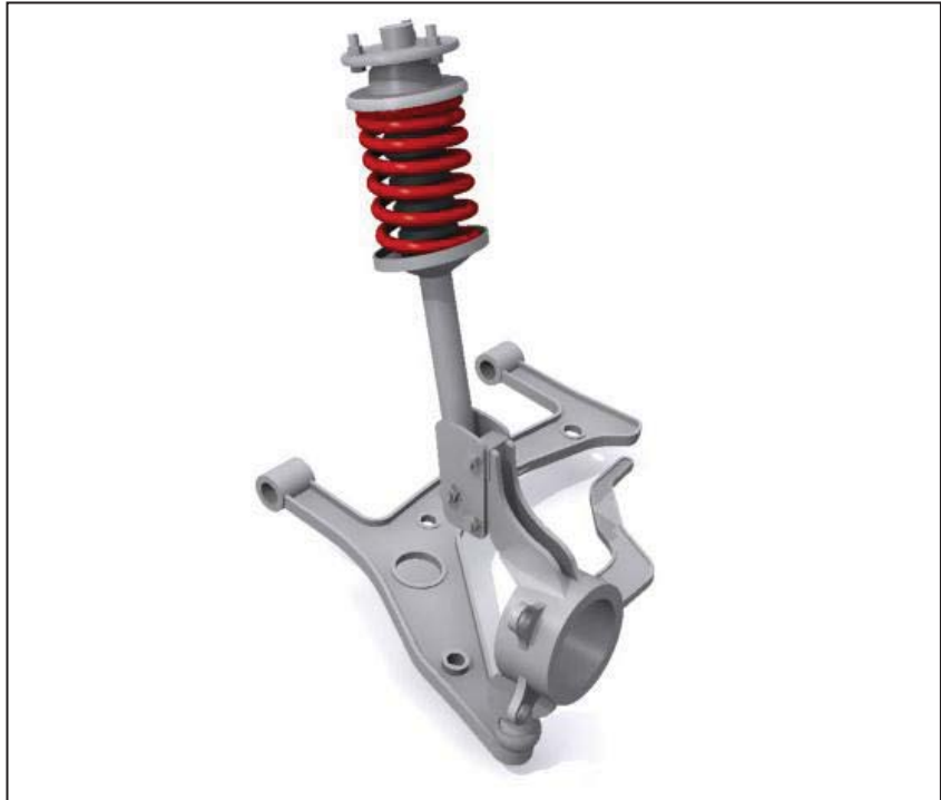
Şekil 1.2 Yay bacaklı ve enine yön verici askı sistemi (Mc Pherson)
