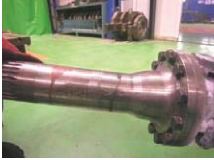
Şekil 2.14 Düşey yorulma testi sonucu
