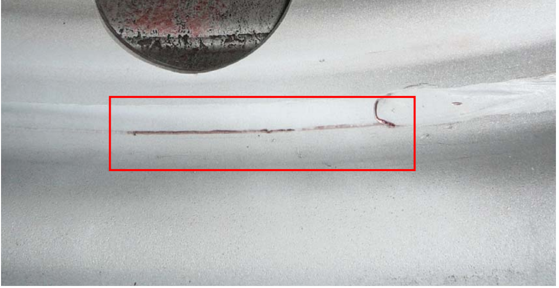
Şekil 5.3 Radyal yorulma testinde 860.000 devir sonrası montaj kaynağında meydana gelen hasar
