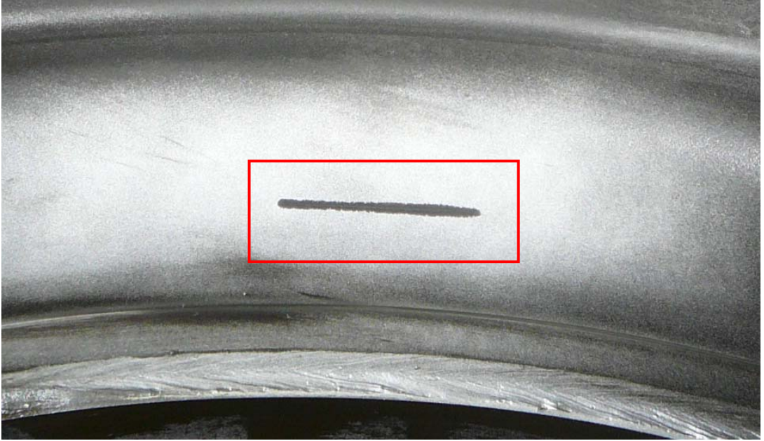
Şekil 5.4 Radyal yorulma testinde 1.120.000 devir sonrası kasnak bölgesinde meydana gelen hasar
