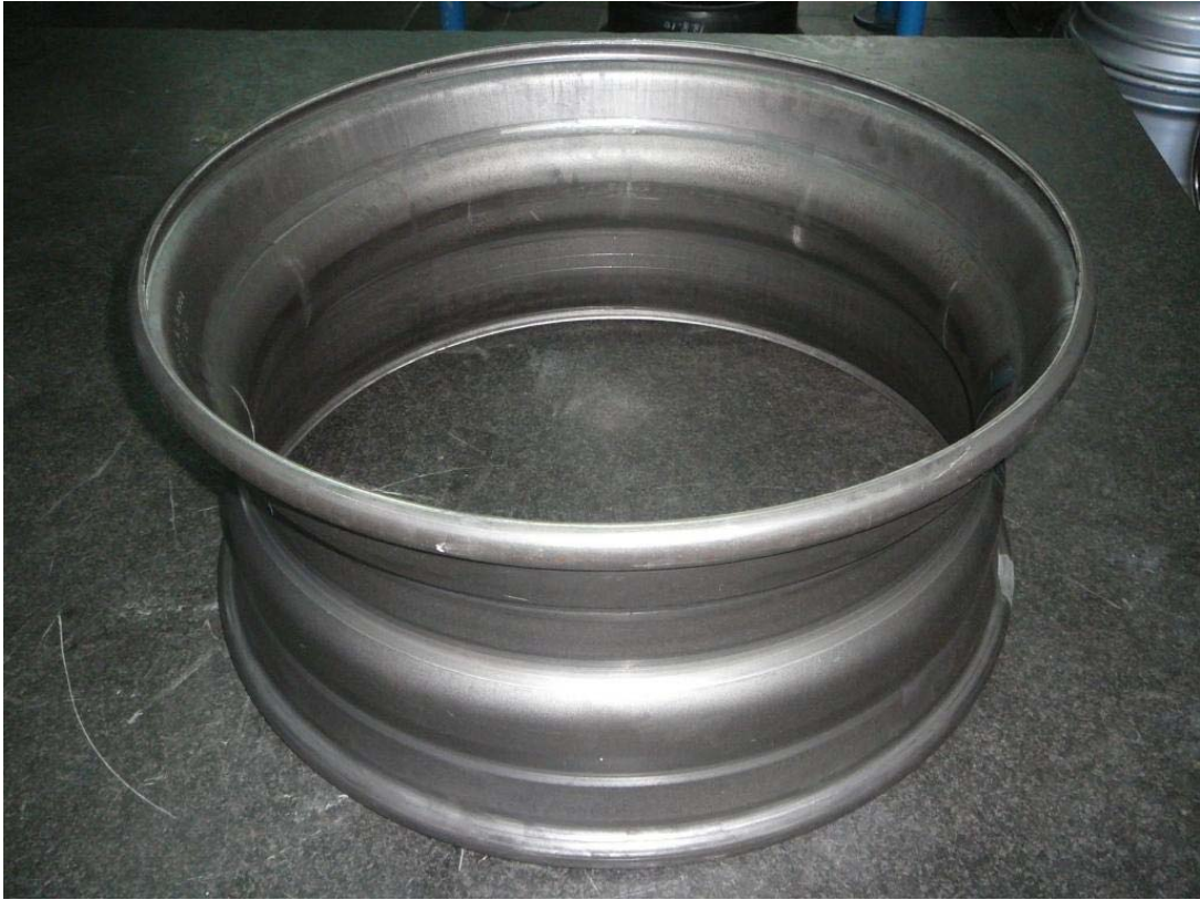
Şekil 2.3 İmalatı tamamlanmış kasnak
