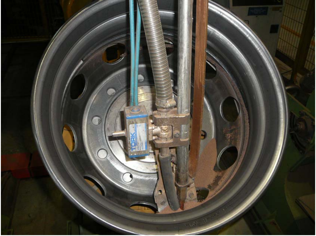
Şekil 2.7 Tozaltı montaj kaynağı
