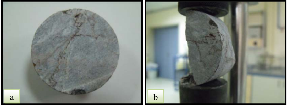
Şekil 6.5 I No'lu ocaktan alınan breşik kireçtaşlarının Brazilian indirekt çekme direnci deneyi öncesindeki (a) ve sonrasındaki (b) görünümü
