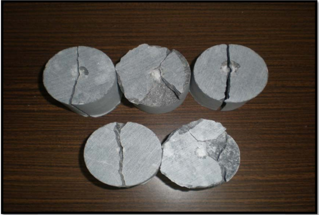
Şekil 6.14 I No'lu ocaktan alınan numunelerin nokta yük dayanım indeksi deneyi sonrası kırılma şekilleri
