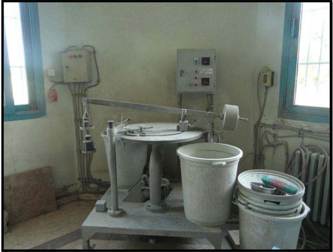
Şekil 6.17 Böhme yüzeysel aşındırma direnci aleti
