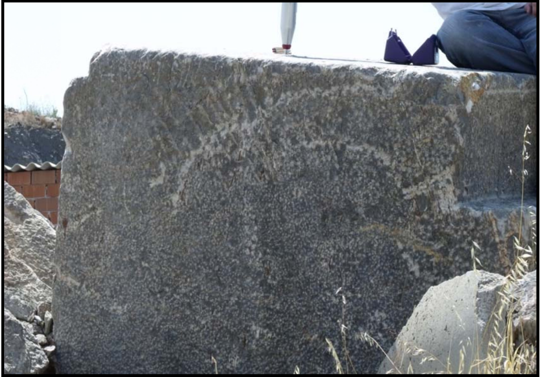
Şekil 5.9 I No'lu ocakta Schmidt çekici deneyi yapılan bloklardan biri
