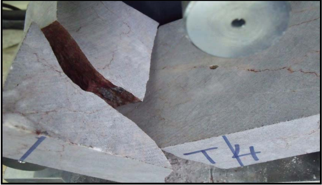
Şekil 6.3 II No'lu antik mermer ocağından alınan Africano Mermerleri'nin eğilme direnci deneyinde içerdiği kılcal süreksizlik düzlemleri boyunca kırılma şekli
