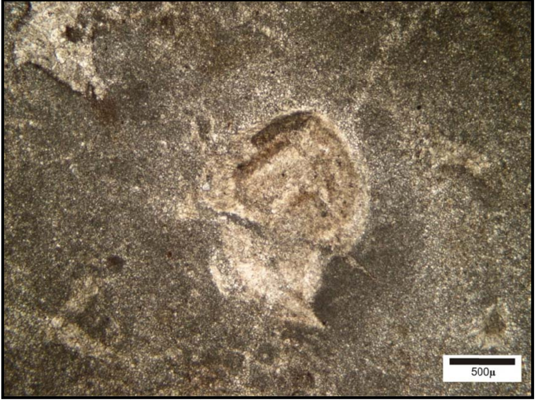
Şekil 3.3 I No'lu antik mermer ocağından üretilen breşik kireçtaşının (Rekristalize kireçtaşı) polarizan mikroskobu altında görünümü (Şekil 3.1a)
