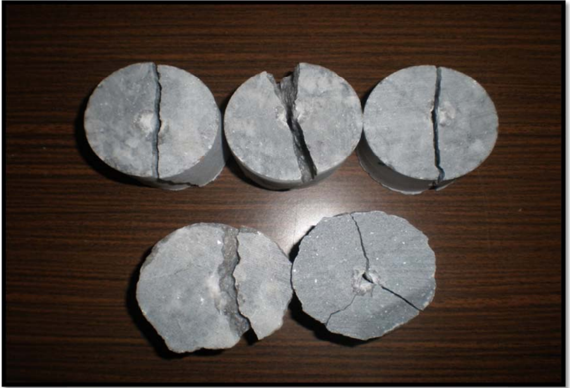
Şekil 6.16 III No'lu ocaktan alınan numunelerin nokta yük dayanım indeksi deneyi sonrası kırılma şekilleri
