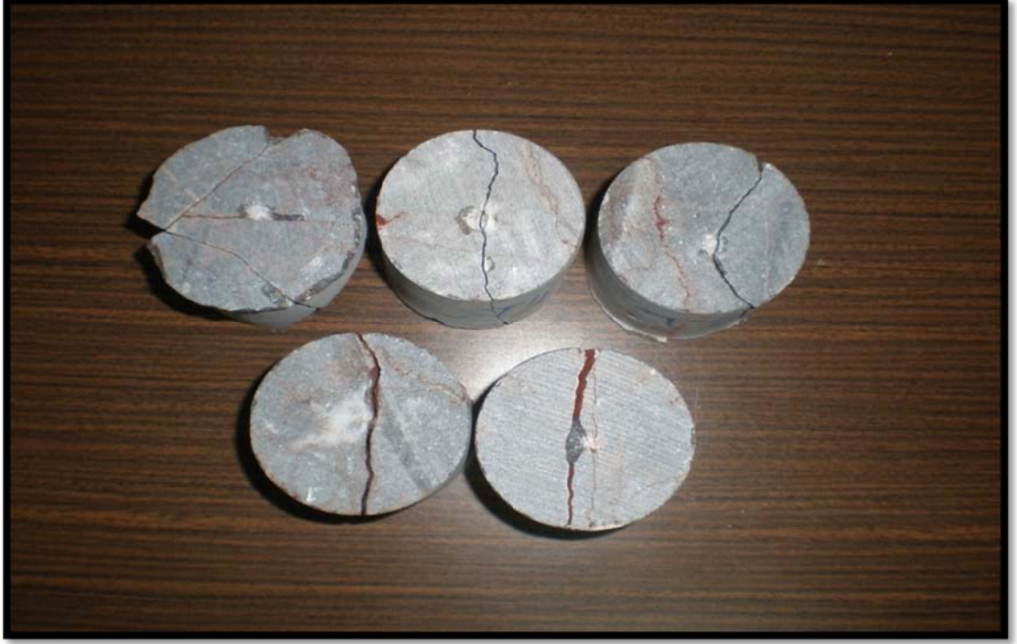
Şekil 6.15 II No'lu ocaktan alınan numunelerin nokta yük dayanım indeksi deneyi sonrası kırılma şekilleri
