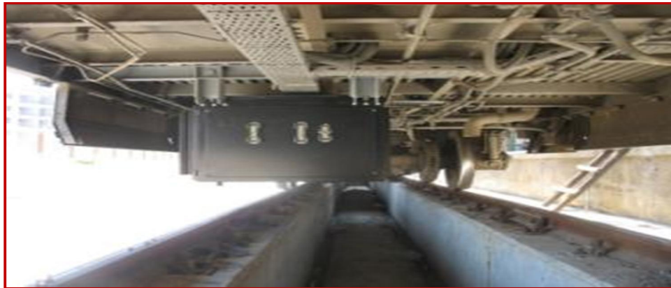
Şekil 2.4 Statik konvertör ünitesinin tren üzerine montaj yeri.
