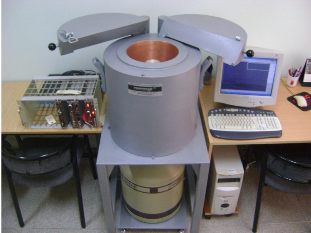
Şeki.3.7 Çalışmada kullanılan gama spektrometre sistemi
