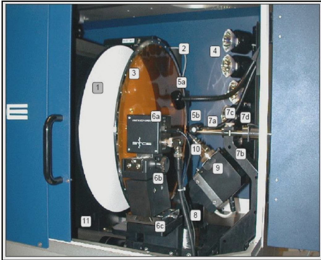
Şekil 2.5 IPDS II cihazının iç kısmının ayrıntıları. (1) Görüntüleme plakası-GP (2) Okuyucu kafa (3) Ana ışın tutucusu (4) Silici ışıklar (5a) ve (5b) Örnek aydınlatma lambaları (6) Video kamera (6a) Kamerayı hareket ettiren tutucu (6b) Optik kısım (7a) Eksenleştirici (7b) Eksenleştirici tutucusu (7c) Ek sabitleme vidası (7d) Güvenlik düğmesi (8) Omega dönü eksen (9) \Phi eksen-numuneyi döndüren eğik eksen (10) Gonyometre başlığı (11) Görüntüleme plakası taşıyıcısı
