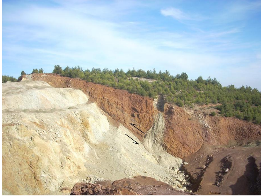
Şekil 3.6 Ters faylı laterit–serpantinit dokanağı, Kuzey Ocak
