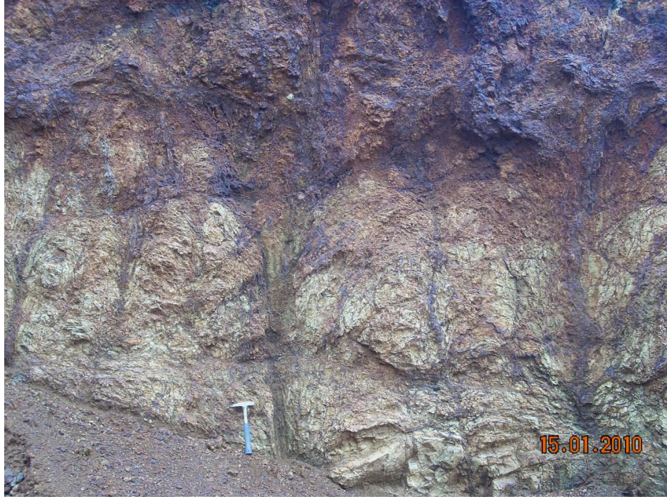
Şekil 2.8 Geçişli laterit–serpantinit dokanağı ve serpantinitlerin ağsı çatlakları boyunca düşey ve yanal yönde ilerlemiş Fe-oksitler
