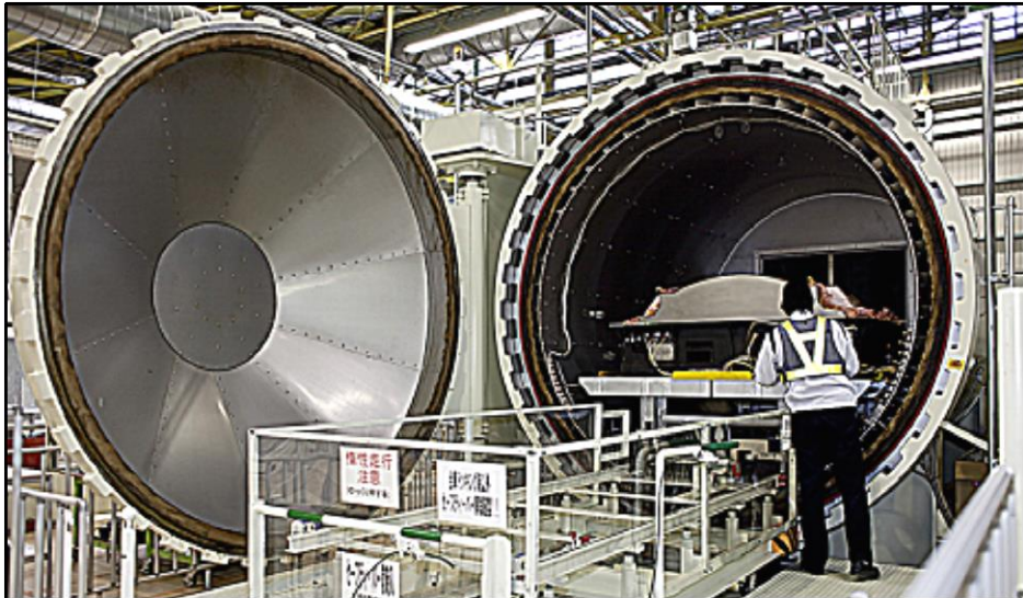
Şekil 2.10 Otoklav fırınına konulan uçak parçası
