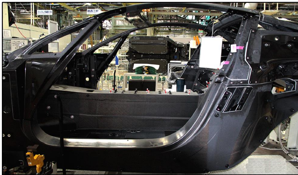
Şekil 2.6 Karbon-epoksi ile yapılmış bir spor otomobil şasesi
