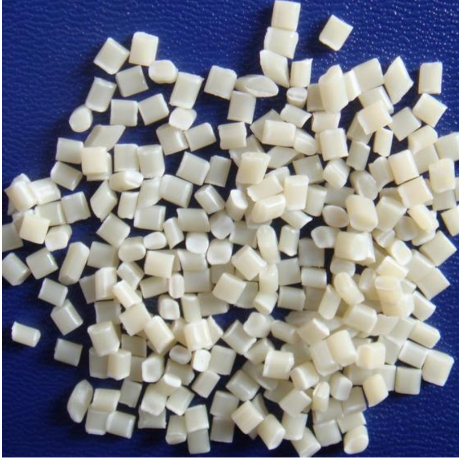
Şekil 2.4 ABS polimeri hammaddesi
