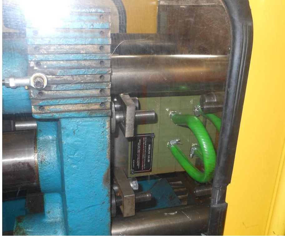
Şekil 5.2 Enjeksiyon işleminin başlangıcı(kalıp kapalı pozisyonda)
