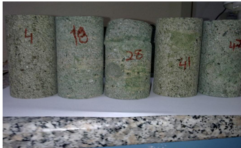
Şekil 8.20 Buca yeşil andezit numunelerinin tuz ( \text{Na}_2\text{SO}_4 ) kristallenmesi deneyi sonrası görünüşleri.
