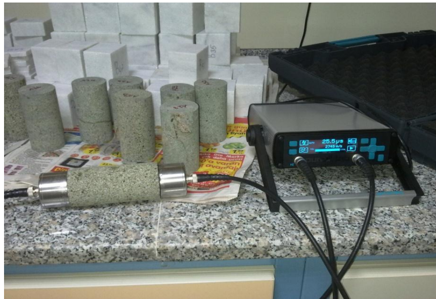
Şekil 8.27 Ultrasonik ses iletkenliği deneyinin uygulanışı.
