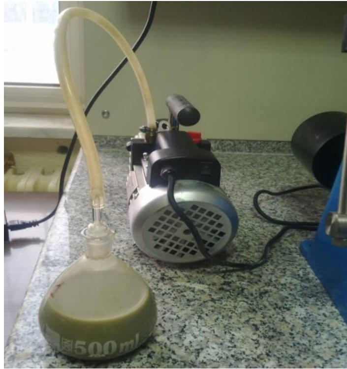
Şekil 6.1 Özgül ağırlık deneyinde kullanılan piknometre ve vakum cihazı.
