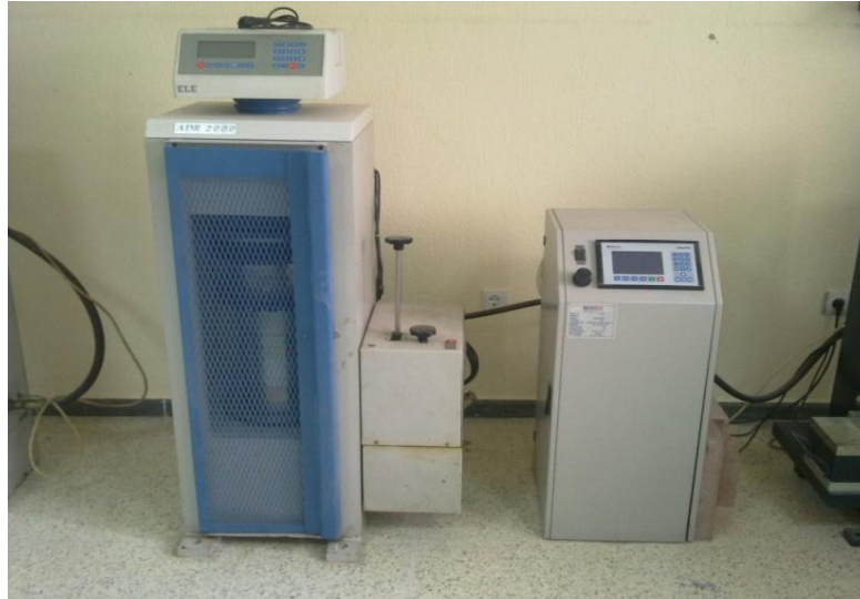
Şekil 6.3 200 ton kapasiteli tek eksenli basınç direnci deney aleti.
