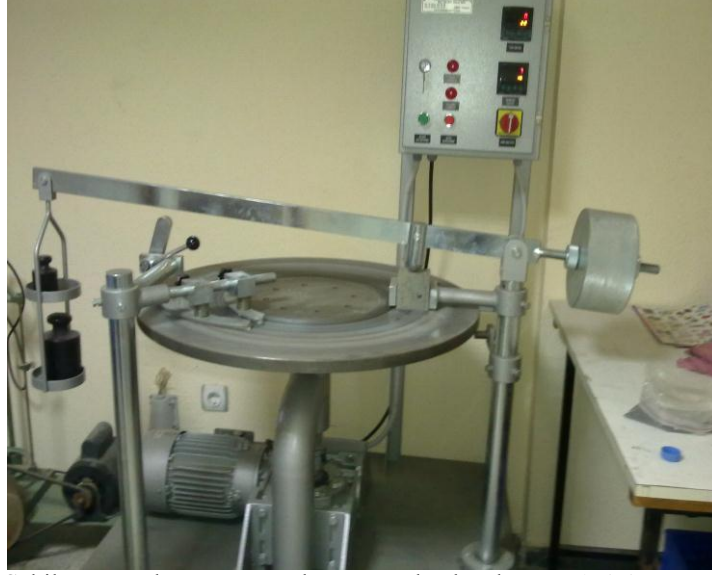
Şekil 6.7 Böhme yüzeysel aşınma kaybı deney aletinin genel görünümü.
