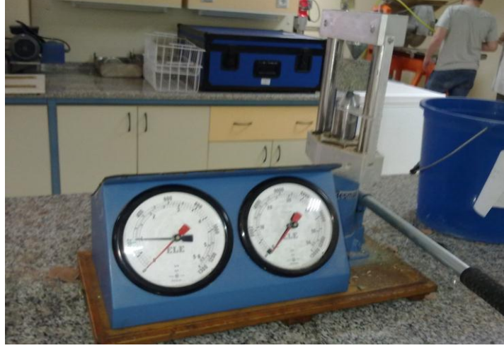
Şekil 6.11 Nokta yükleme dayanım aleti.
