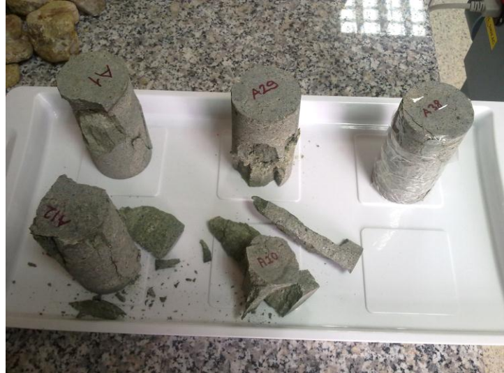
Şekil 6.5 Tek eksenli basınç direnci deneyi sonucunda andezit numunelerinin kırılma şekilleri.
