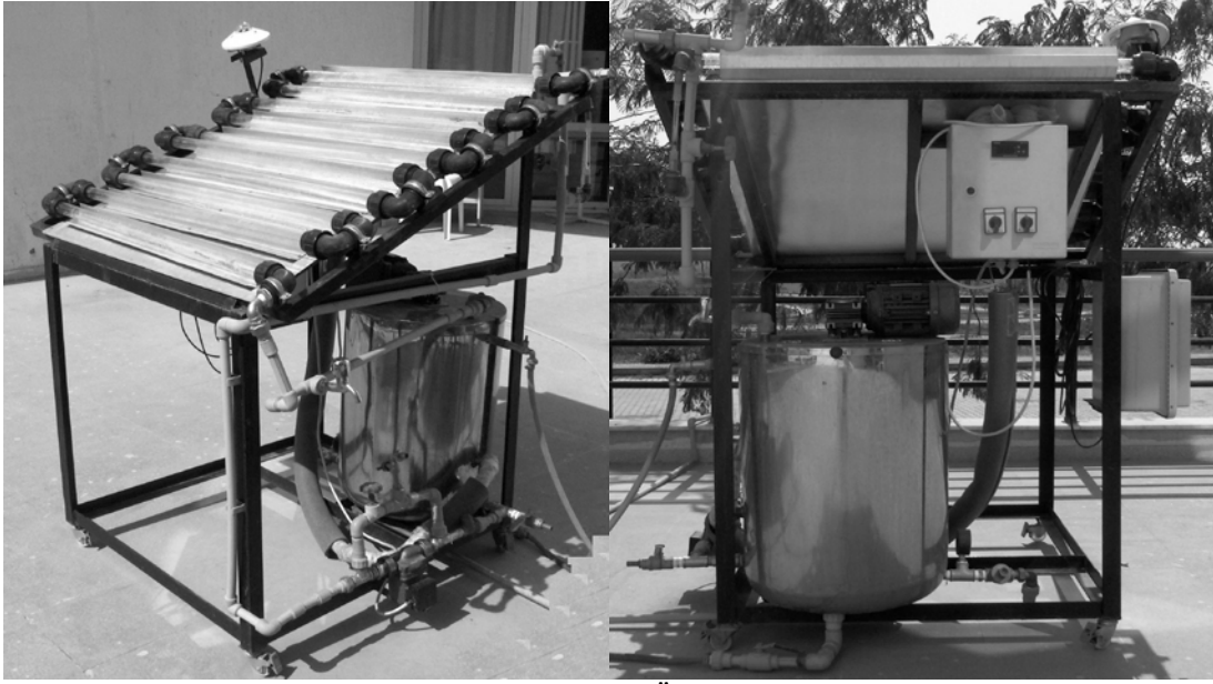
Şekil 1. (a) Güneş Enerjisi Ünitesinin önden görünümü (b) Güneş Enerjisi Ünitesinin arkadan görünümü
