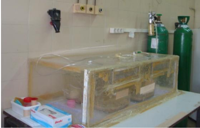
Resim 3. Özel düzenek içinde % 10 oksijen ve % 90 azot gaz karışımına maruz bırakılan deney grupları
