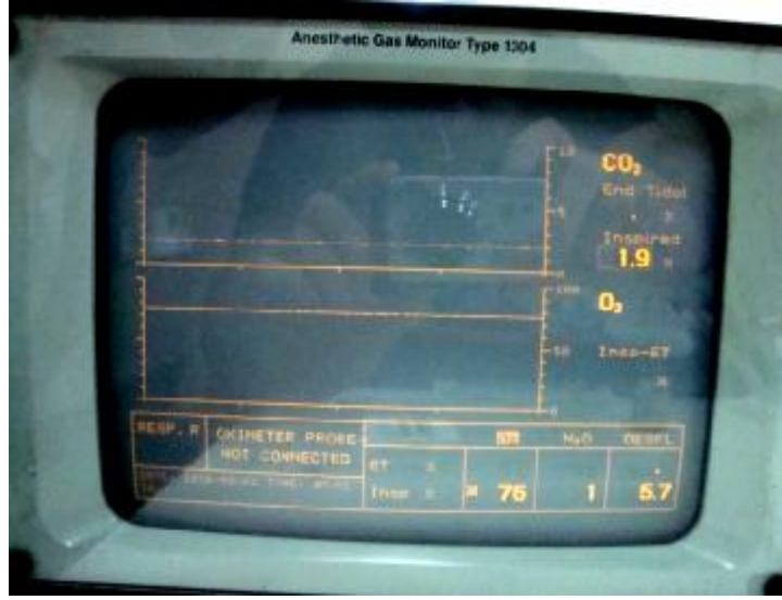
Resim 4. Deney düzeneğine bağlı halde olan anestezi gaz monitörü ile oksijen, karbondioksit ve desfluran ölçümlerinin yapılması
