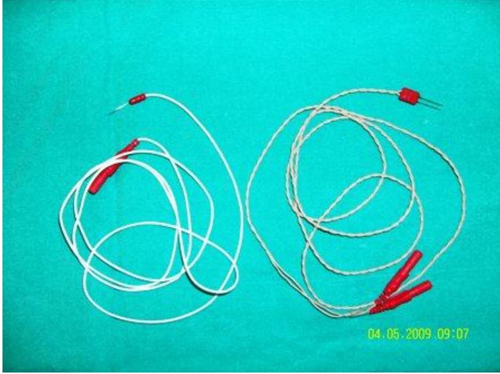
Şekil 8 Tek iğneli toprak elektrot ve çift iğneli paslanmaz çelik elektrot
