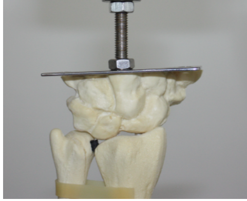
Resim 2. Yüklemeye hazırlanmış el bileği modeli
