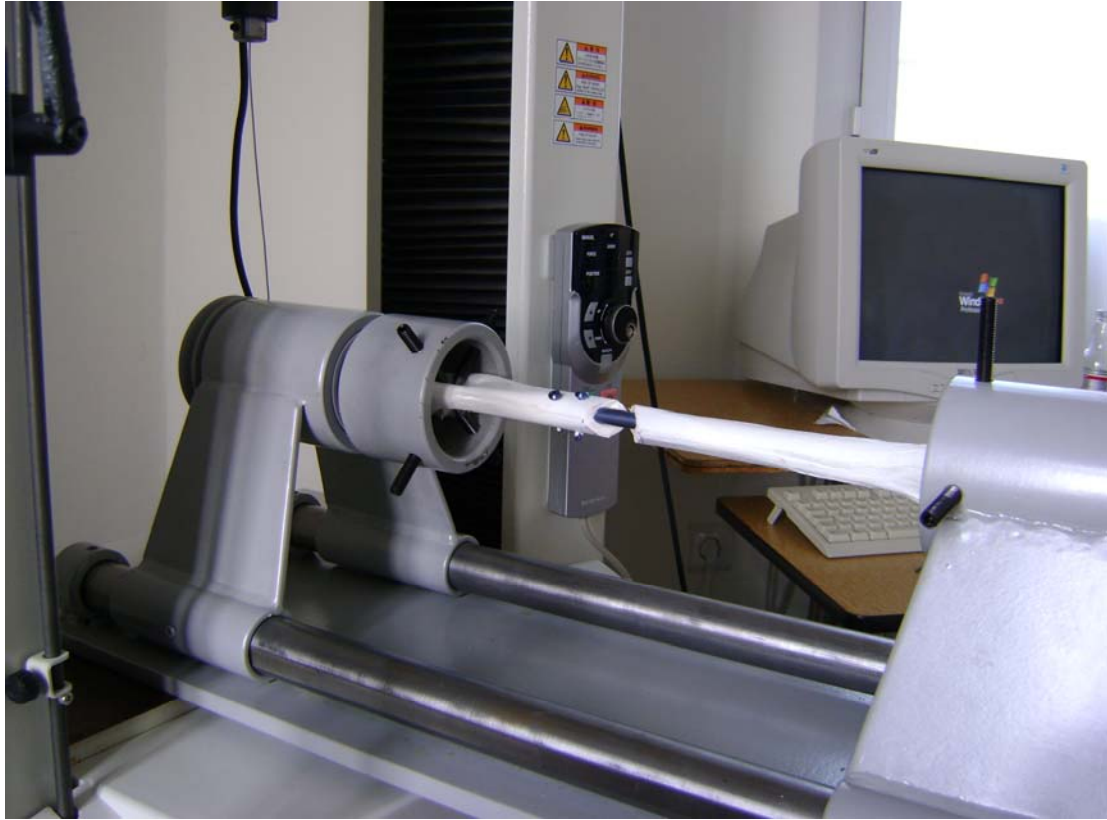
Resim 9 Burulma aparatının sabit bölümünde deneğin santralizasyonu
