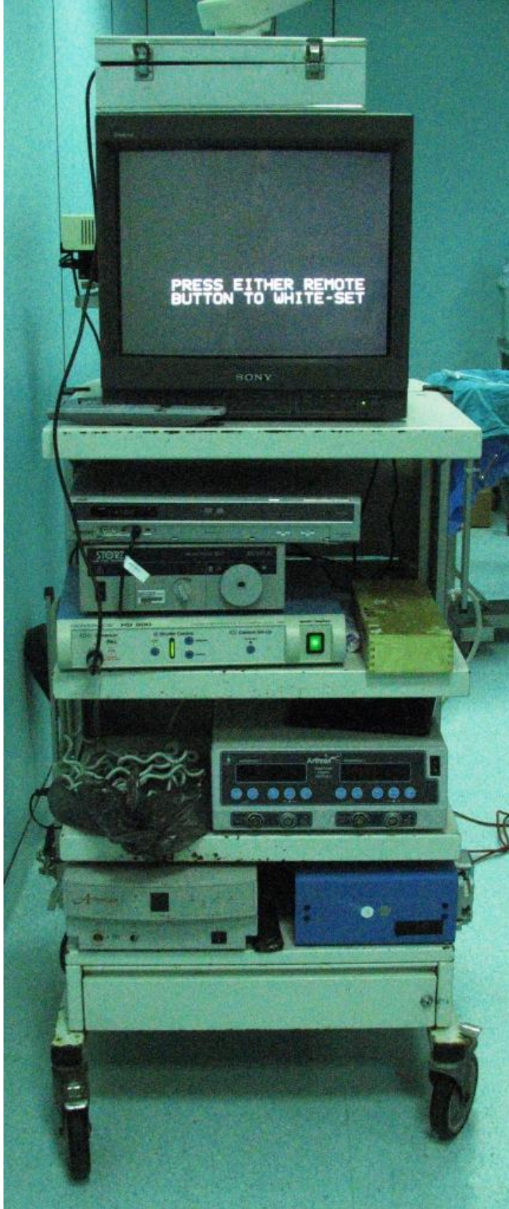
Resim 8: Görüntüleme sistemi. Monitör, ışık kaynağı, görüntü kaydedici.
