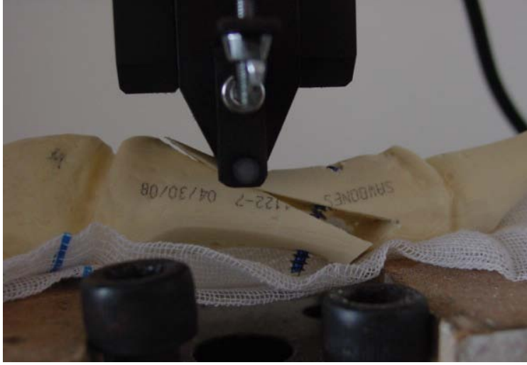
Şekil 37: Ofset V osteotomisi yetmezlik resmi
