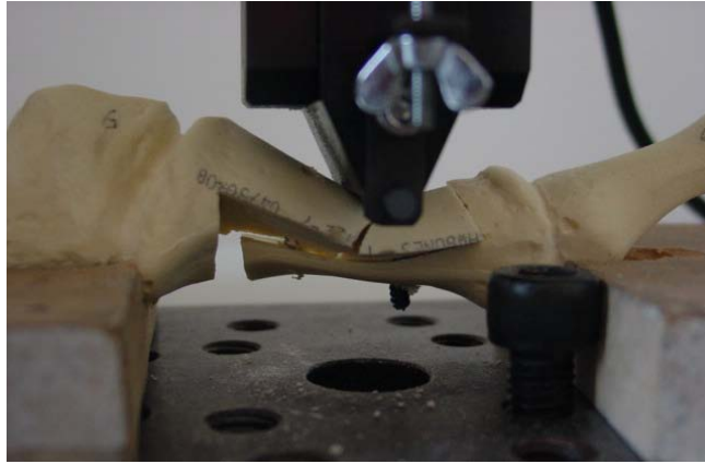
Şekil 36: Scarf osteotomisi yetmezlik resmi
