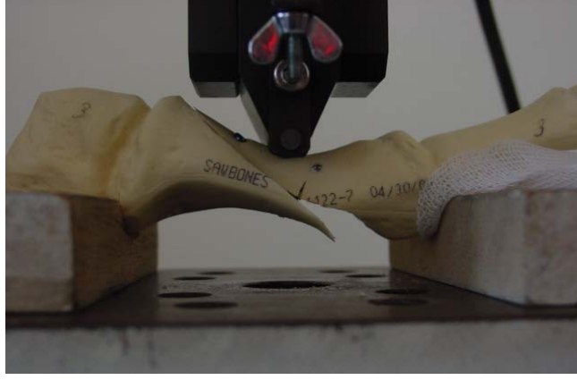
Şekil 34: Ludloff osteotomisi yetmezlik resmi
